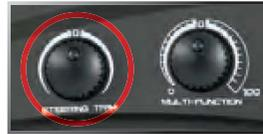
**Note :** La gestion de stabilité Traxxas (TSM) doit être complètement hors tension durant la calibration du levier de direction. Voir la page 24 pour réglages de TSM.
