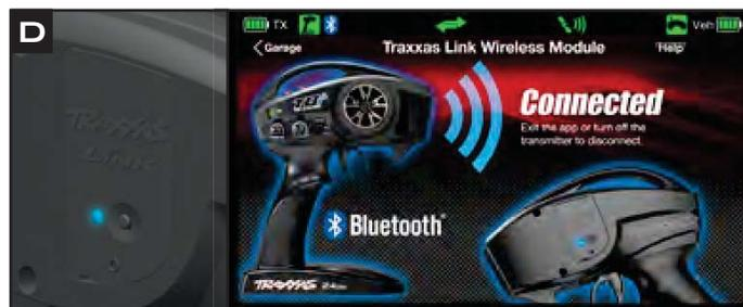
5. L'icône Bluetooth® dans la barre d'état s'allume d'une couleur bleu constant, et le voyant DEL du module s'allume d'une couleur bleue constant (D).
