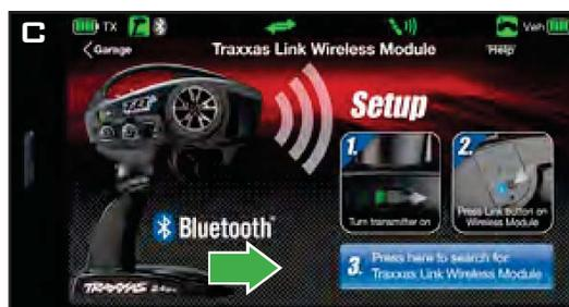
4. Sous 10 secondes, appuyez sur le bouton "Press here to search for Traxxas Link Wireless Module" (Rechercher pour module sans fil Traxxas Link) sur votre périphérique mobile (C).
