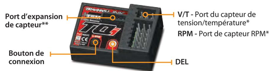
\*Ports de capteur accessoire à utiliser avec les capteurs standard de télémétrie pour la tension/température et RPM.
