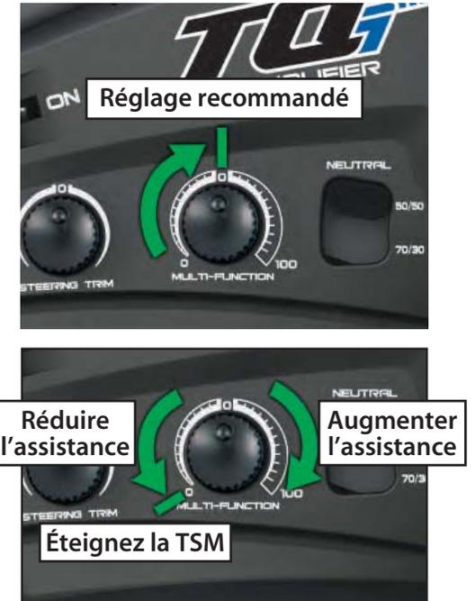
Lorsqu'on conduit sur des surfaces offrant une certaine adhérence, il peut être souhaitable d'atténuer le réglage de la TSM pour obtenir des sensations de pilotage plus « libres » lors des dérapages contrôlés, des glissades, etc. Sur les surfaces offrant très peu d'adhérence (terre meuble, béton lisse, glace/neige), augmentez la TSM pour une accélération et un contrôle maximaux.
