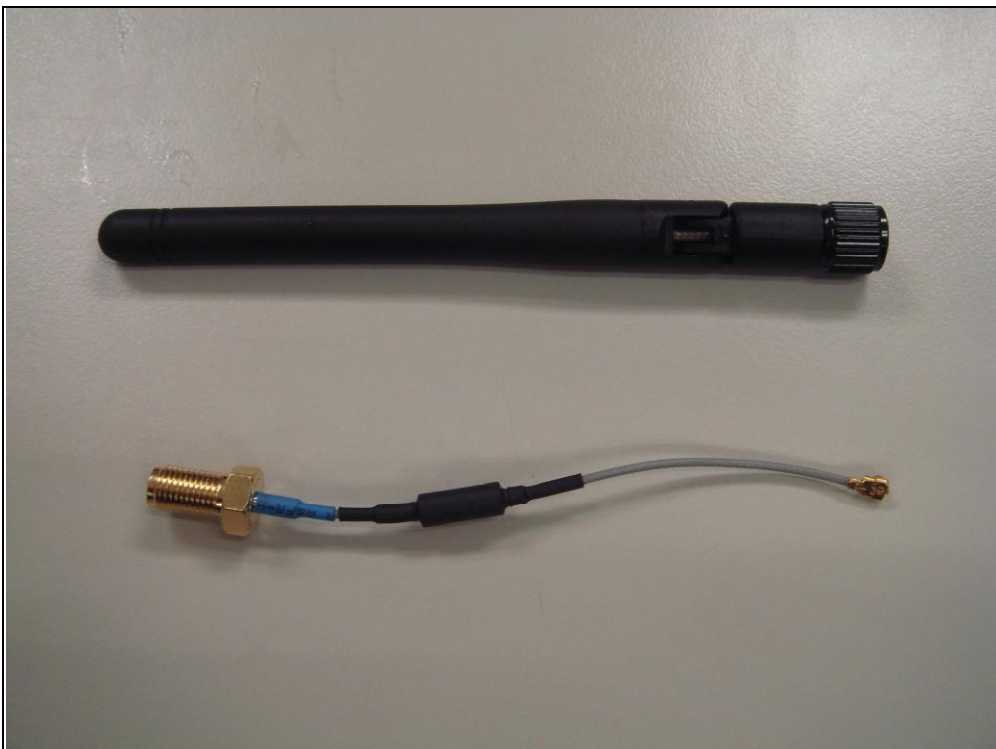
THW0157A & ANT CABLE Mini 1.13 L=80mm
