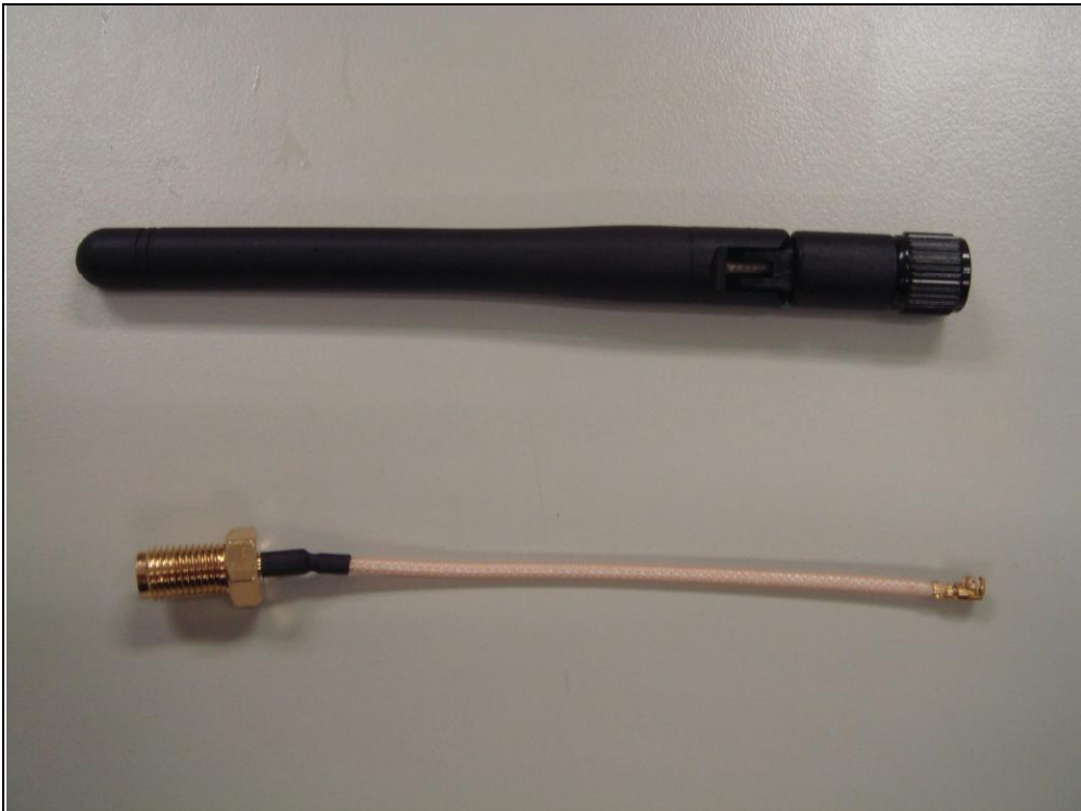
THW0157A & ANT CABLE Mini 1.13 L=150mm
