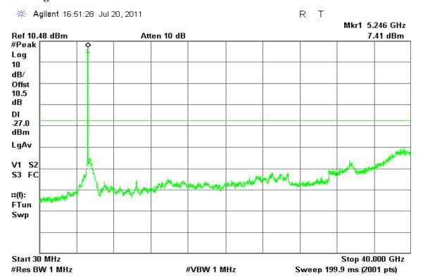
$\underline{IEEE~802.11n~HT~20~MHz~mode~/~5180} \sim 5240MHz~/~Chain~0$
