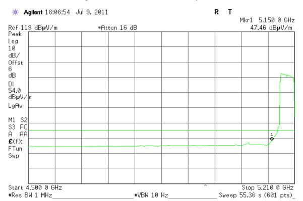
Band Edges (IEEE 802.11n HT 40 MHz mode / CH 5230 MHz)
