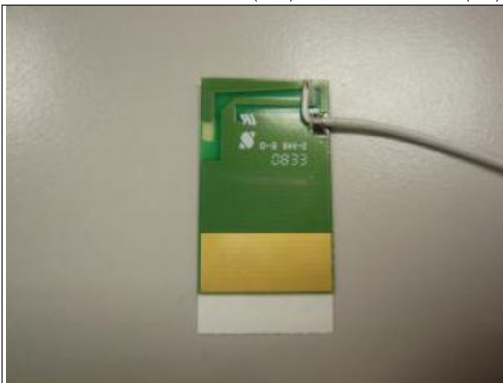
Antenna 51: WDAN-M1WC1002-DF (Main) / WDAN-M1WC1001-DF (Aux)
