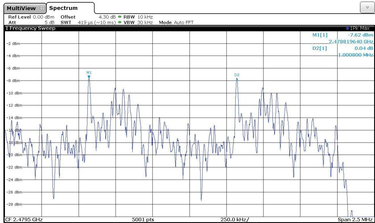
Summary of Channel separation measurements -  $\pi/4$  DQPSK
