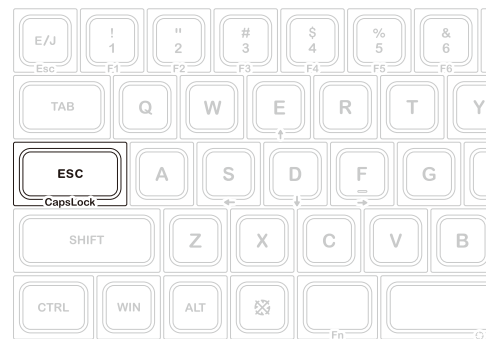
スイッチ2: CapsLockキーのCapsLockとEscの表裏を入れ替え 1と2を同時にオンにする場合に必要なキーキャップも付属しています
