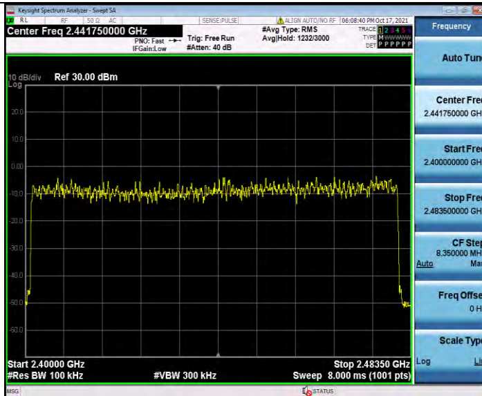
\pi/4 DQPSK Modulation
