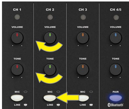
Ajuste cada canal de la misma forma. Use los mandos VOLUME de canal para ajustar el volumen percibido relativo de cada canal para el balance global y ajuste después con el mando MASTER VOLUME el volumen de la mezcla final.
