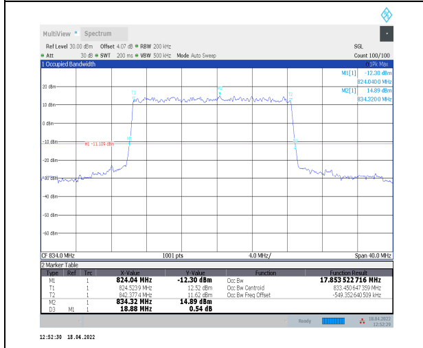
1-N5--15-20-L-2-DFT-PI2BPSK-Outer_Full-100@0-A nt0-17.854-18.880-≤20-PASS
