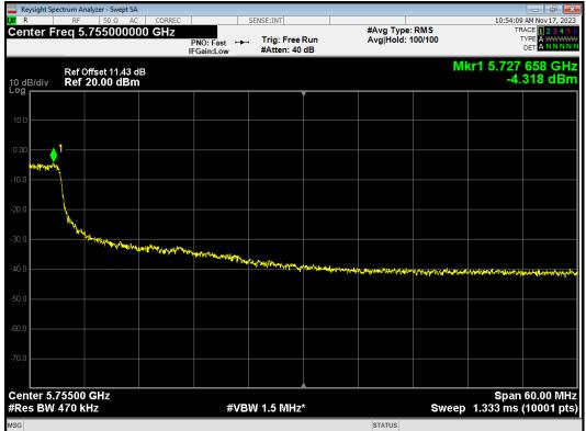
PSD 802.11ac(VHT40) 5710MHz Ant2
