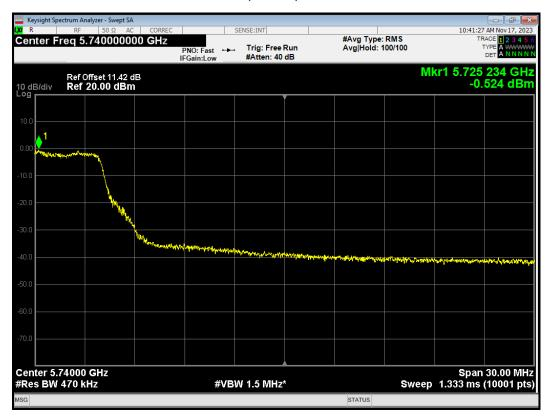
PSD 802.11ac(VHT20) 5720MHz Ant2
