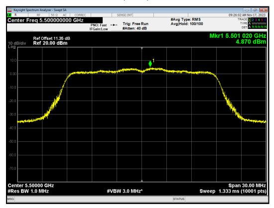
PSD 802.11ac(VHT20) 5500MHz Ant2
