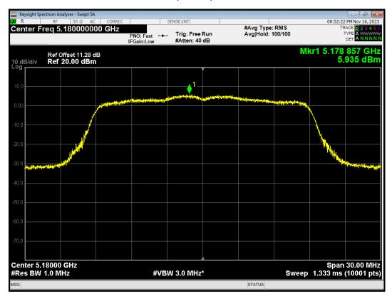
PSD 802.11ac(VHT20) 5180MHz Ant2
