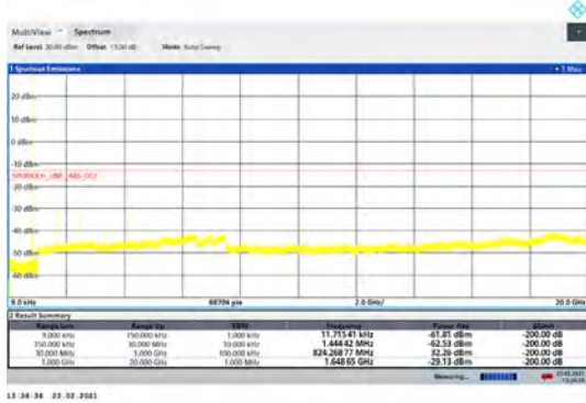
GSM 850 CH-Middle 9kHz ~ 20GHz
