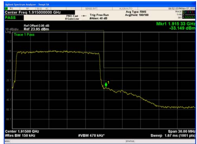
LTE Band 25 20MHz QPSK 1RB CH-High
