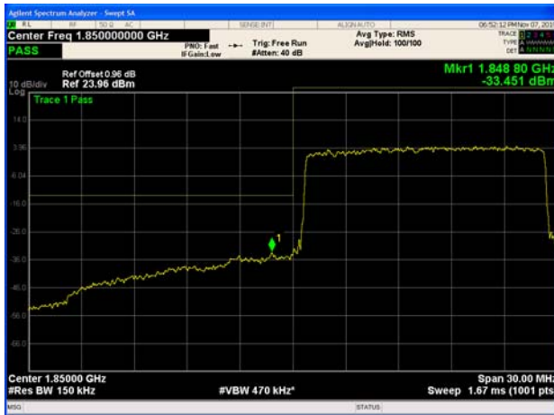
LTE Band 25 20MHz QPSK 1RB CH-Low
