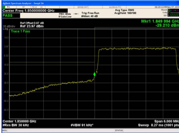
LTE Band 25 5MHz QPSK 1RB CH-Low
