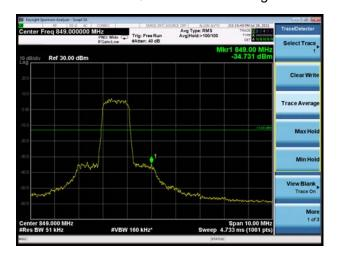
LTE eMTC Band 26 16QAM 1.4MHz CH-Low 1RB
