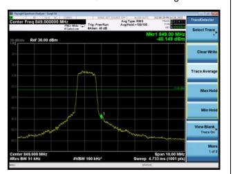
LTE eMTC Band 26 QPSK 5MHz CH-Low 1RB
