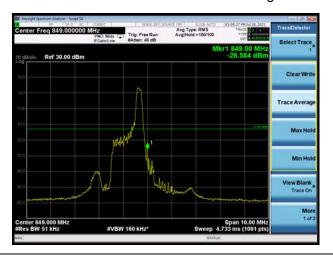
LTE eMTC Band 26 QPSK 5MHz CH-Low 100%RB
