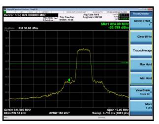
LTE eMTC Band 26 QPSK 10MHz CH-High 100%RB
