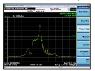
LTE eMTC Band 26 QPSK 1.4MHz CH-Low 100%RB
