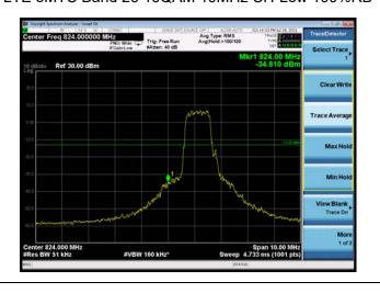
LTE eMTC Band 26 16QAM 10MHz CH-High 100%RB
