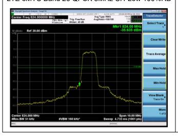
LTE eMTC Band 26 QPSK 5MHz CH-High 100%RB
