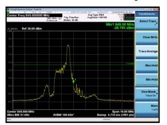
LTE eMTC Band 26 16QAM 3MHz CH-Low 100%RB
