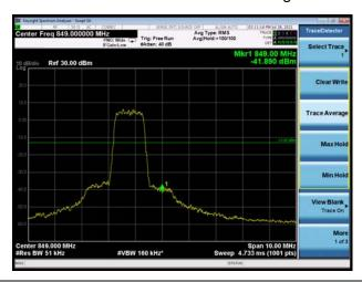
LTE eMTC Band 26 QPSK 15MHz CH-Low 1RB
