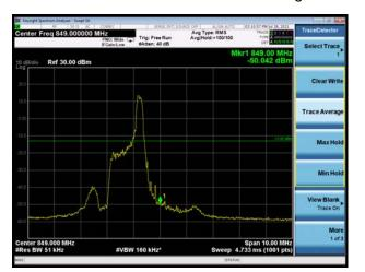
LTE eMTC Band 26 QPSK 10MHz CH-Low 100%RB
