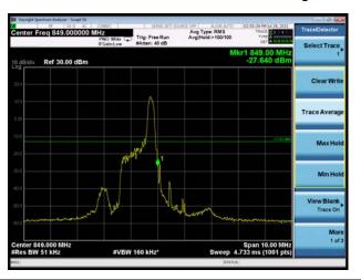
LTE eMTC Band 26 16QAM 1.4MHz CH-Low 100%RB
