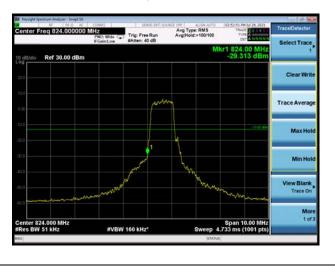
LTE eMTC Band 26 16QAM 1.4MHz CH-High 100%RB
