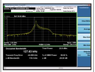
NB-IOT Band 25 QPSK 3.75kHz 1@0 CH-Low
