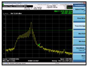
NB-IOT Band 2 QPSK 15kHz 12@0 CH-Low
