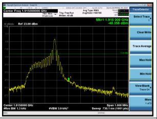
NB-IOT Band 25 QPSK 3.75kHz 1@0 CH-Low
