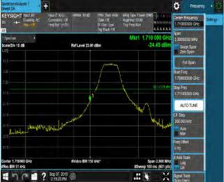
LTE Band 4\_1.4MHz\_16QAM\_19957\_1RB#0\_-26.00\_PASS
