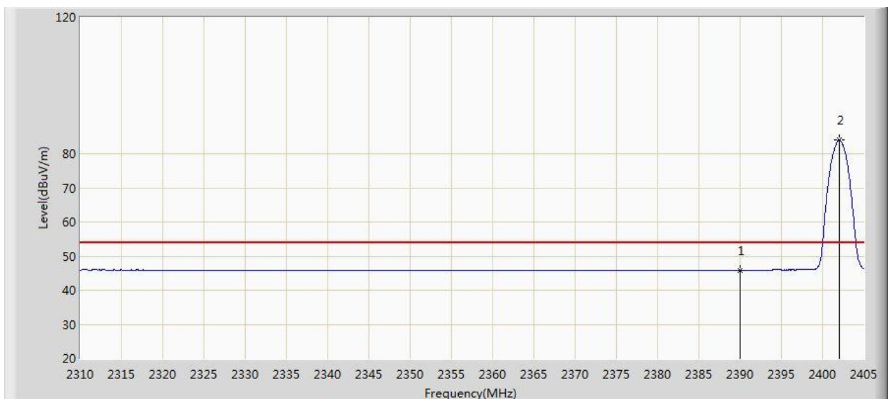
Figure 58: Band Edge, TM4, Horizontal, AV
