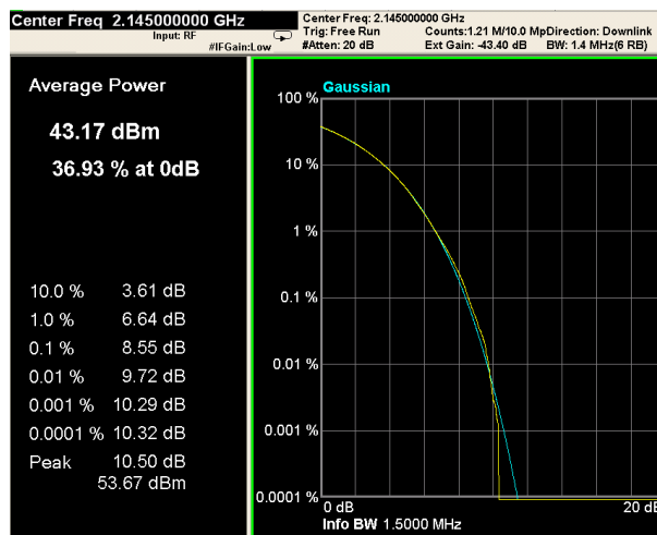
PAR measure example (LTE 1,4MHz QAM)
