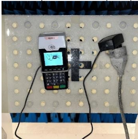
Photo Setup : anechoic chamber (Z axis)
