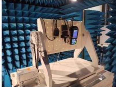
Photo Setup : anechoic chamber (Z axis)
