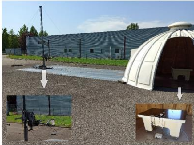
Photo Setup – OATS (Biconic antenna)
