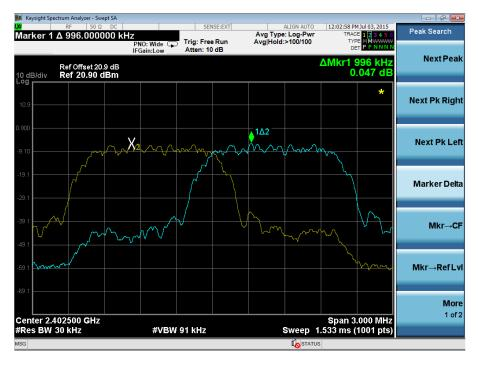
Bluetooth, pi/4 DQPSK, Channel Separation Plot
