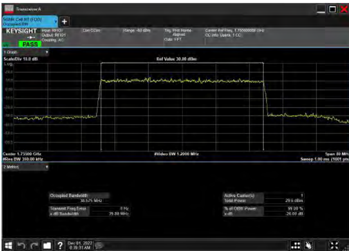
DC_2A_n66A_10MHz|40MHz_15kHz_1880MHz|1760MHz_Q PSK|DFT-s-OFDM QPSK_RB1@50|RB216@0
