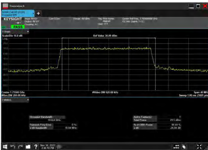
DC_5A_n66A_10MHz|20MHz_15kHz_836.5MHz|1770MHz_Q PSK|CP-OFDM 64 QAM_RB1@50|RB106@0
