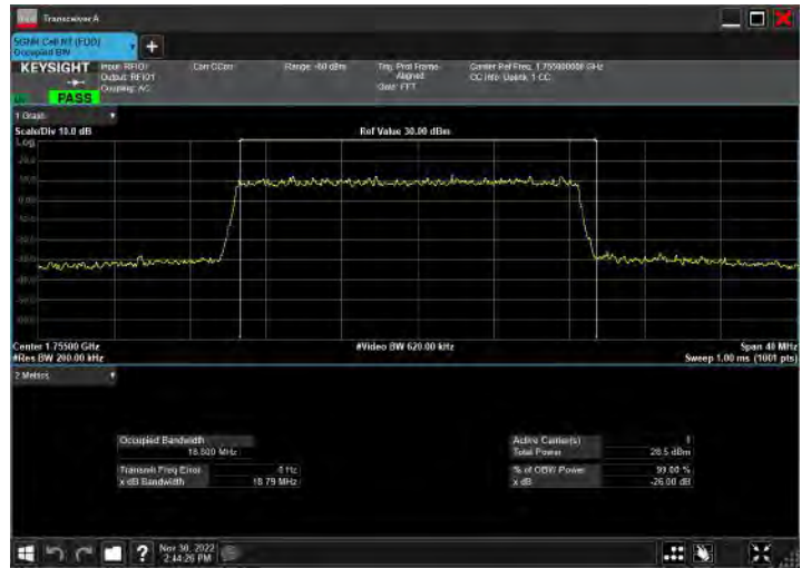
DC_5A_n66A_10MHz|20MHz_15kHz_836.5MHz|1770MHz_Q PSK|DFT-s-OFDM 256 QAM_RB1@50|RB100@0
