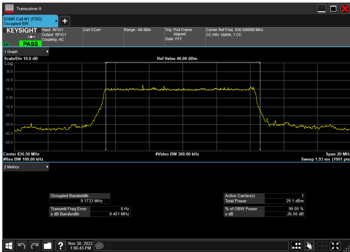
DC_2A_n5A_10MHz|10MHz_15kHz_1880MHz|836.5MHz_QP SK|CP-OFDM QPSK_RB1@50|RB52@0
