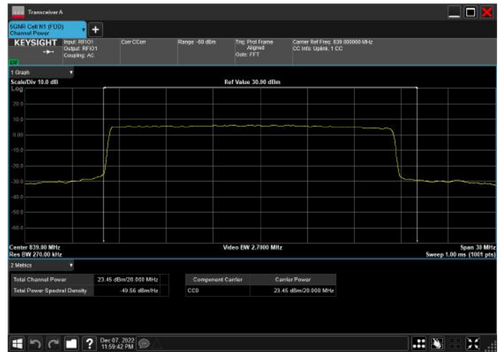
n5_20MHz_15kHz_839MHz_DFT-s-OFDM PI/2 BPSK_RB100@0
