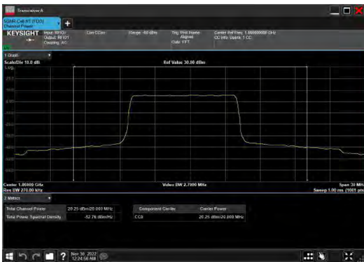
DC_5A_n2A_10MHz|20MHz_15kHz_829MHz|1860MHz_QPS K|DFT-s-OFDM PI/2 BPSK_RB12@0|RB50@25
