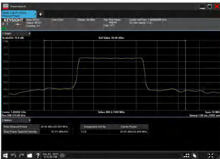
DC_66A_n2A_10MHz|20MHz_15kHz_1715MHz|1860MHz_QPSK|DFT-s-OFDM PI/2 BPSK_RB12@0|RB50@25
