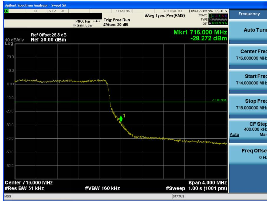
BAND 12. Upper Extended Band Edge Plot (5M BW Ch.23155 QPSK\_RB25\_0)
