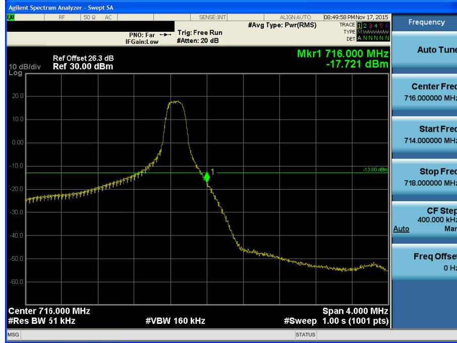
BAND 12. Upper Band Edge Plot (5M BW Ch.23155 QPSK\_RB25\_Offset 0)
