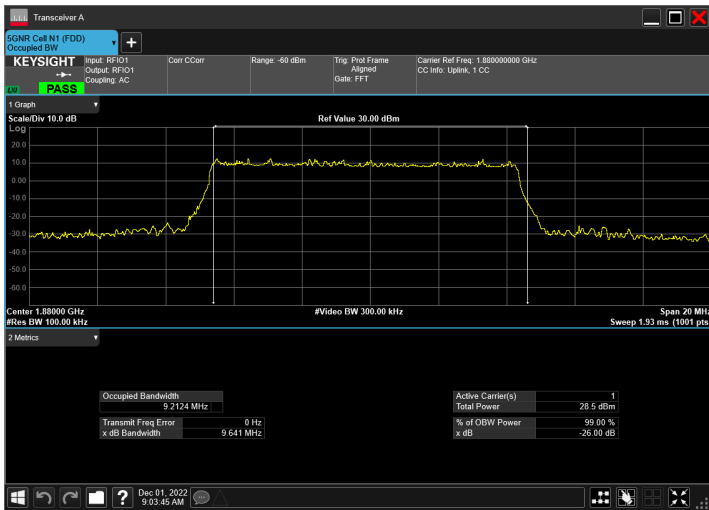
DC_66A_n2A_10MHz|10MHz_15kHz_1745MHz|1880MHz_Q PSK|CP-OFDM QPSK_RB1@50|RB52@0
