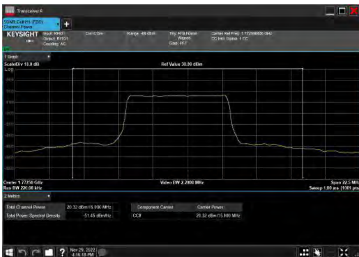
DC_2A_n66A_10MHz|15MHz_15kHz_1905MHz|1772.5MHz_ QPSK|DFT-s-OFDM PI/2 BPSK_RB12@38|RB36@18
