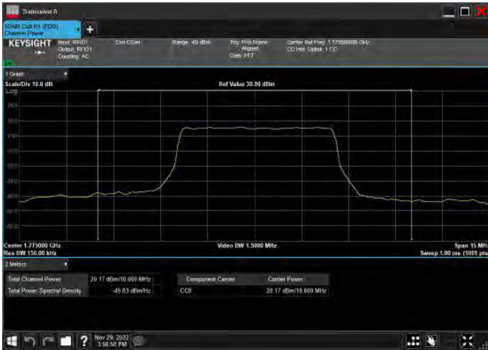
DC_2A_n66A_10MHz|10MHz_15kHz_1905MHz|1775MHz_Q PSK|CP-OFDM QPSK_RB12@38|RB26@13
