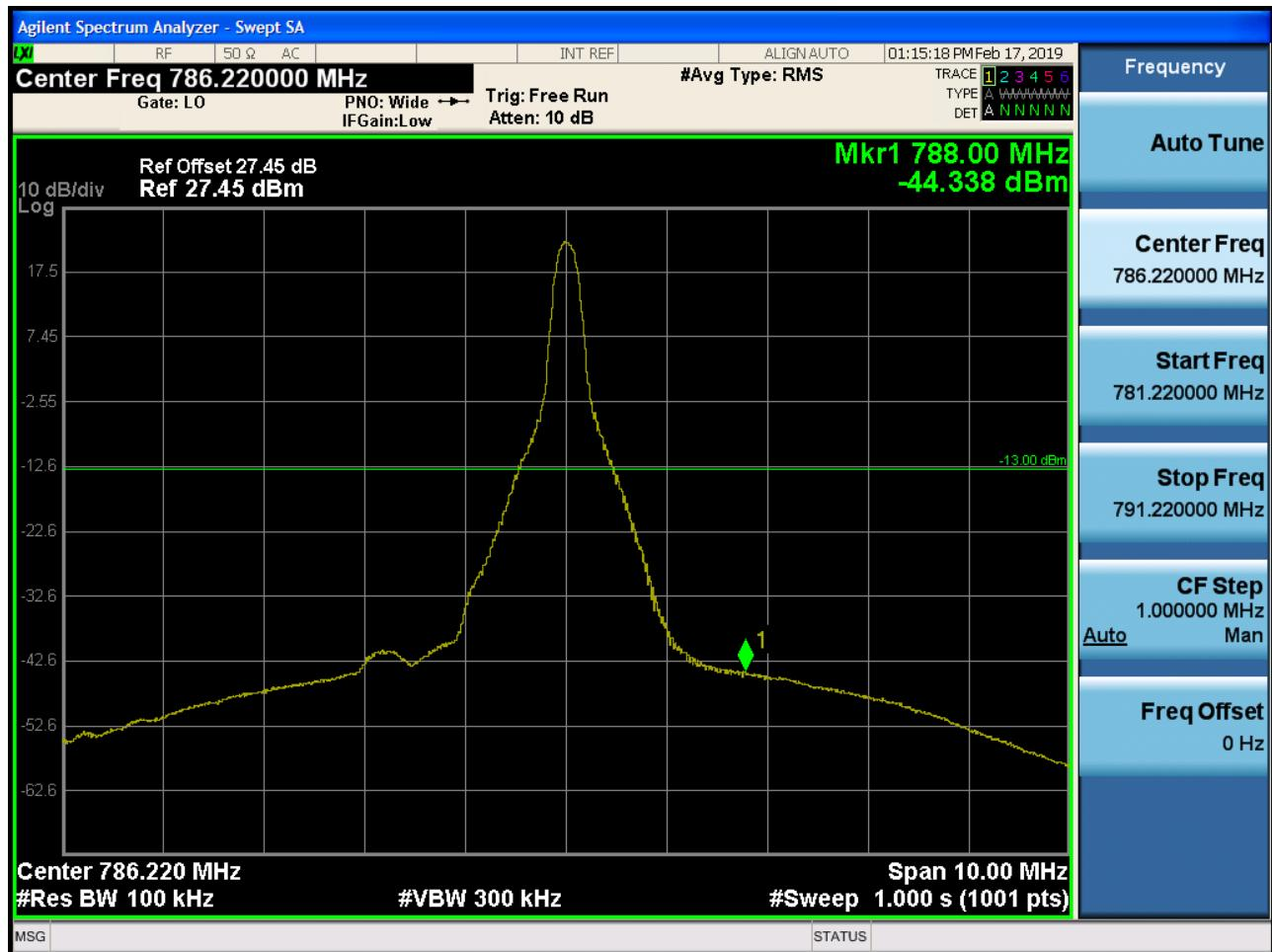
Band 13 Upper Band Edge Plot (10M BW Ch.23230 QPSK\_ QPSK\_Full RB)
