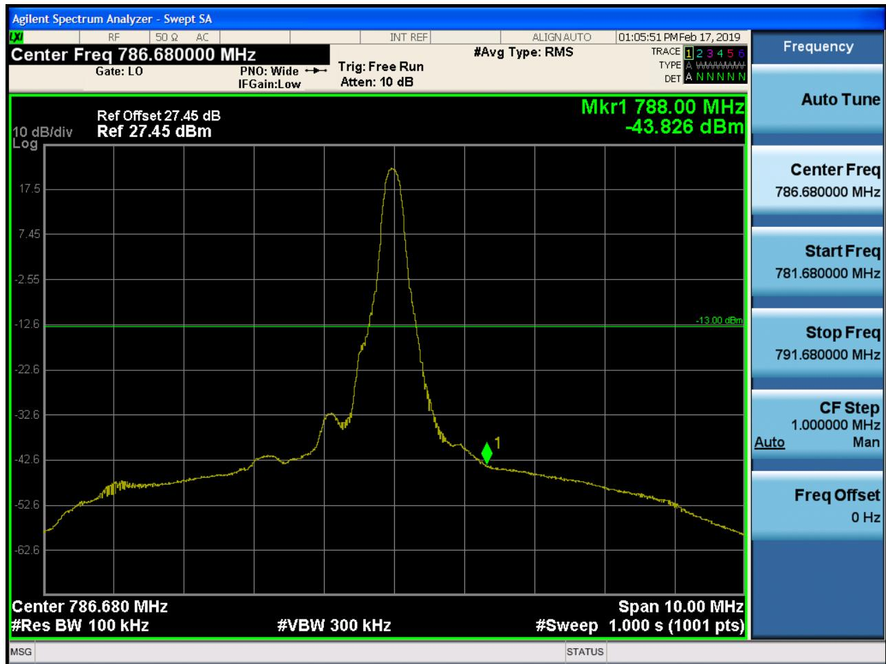
Band 13 Upper Band Edge Plot (5M BW Ch.23255 QPSK\_Full RB)
