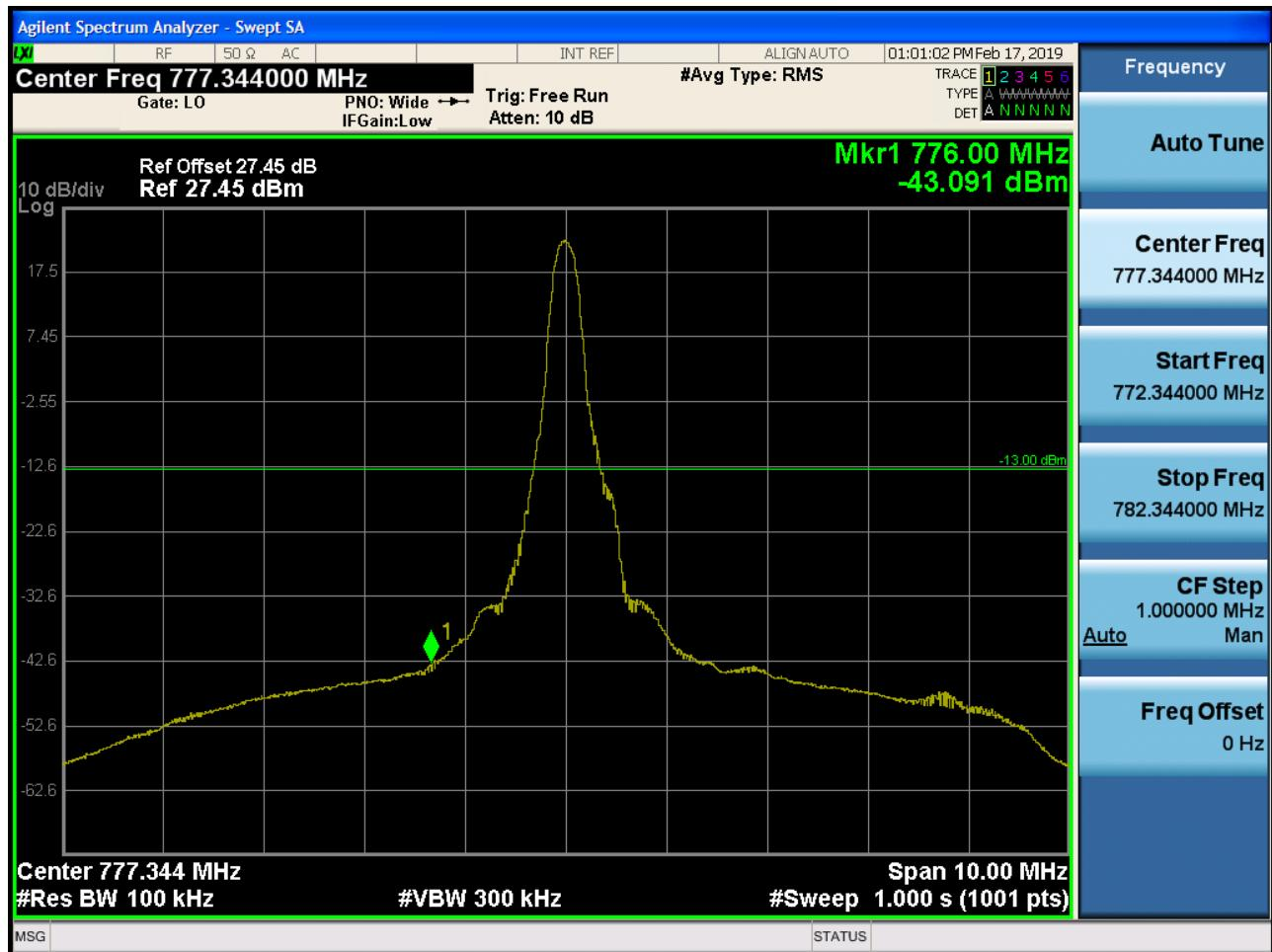
Band 13 Lower Band Edge Plot (5M BW Ch.23205 QPSK\_Full RB)
