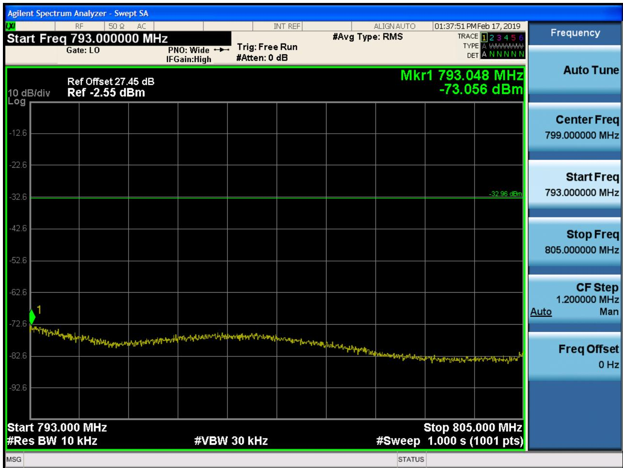
Band 13 Upper Band Edge Plot (10M BW Ch.23230 QPSK\_1RB)
