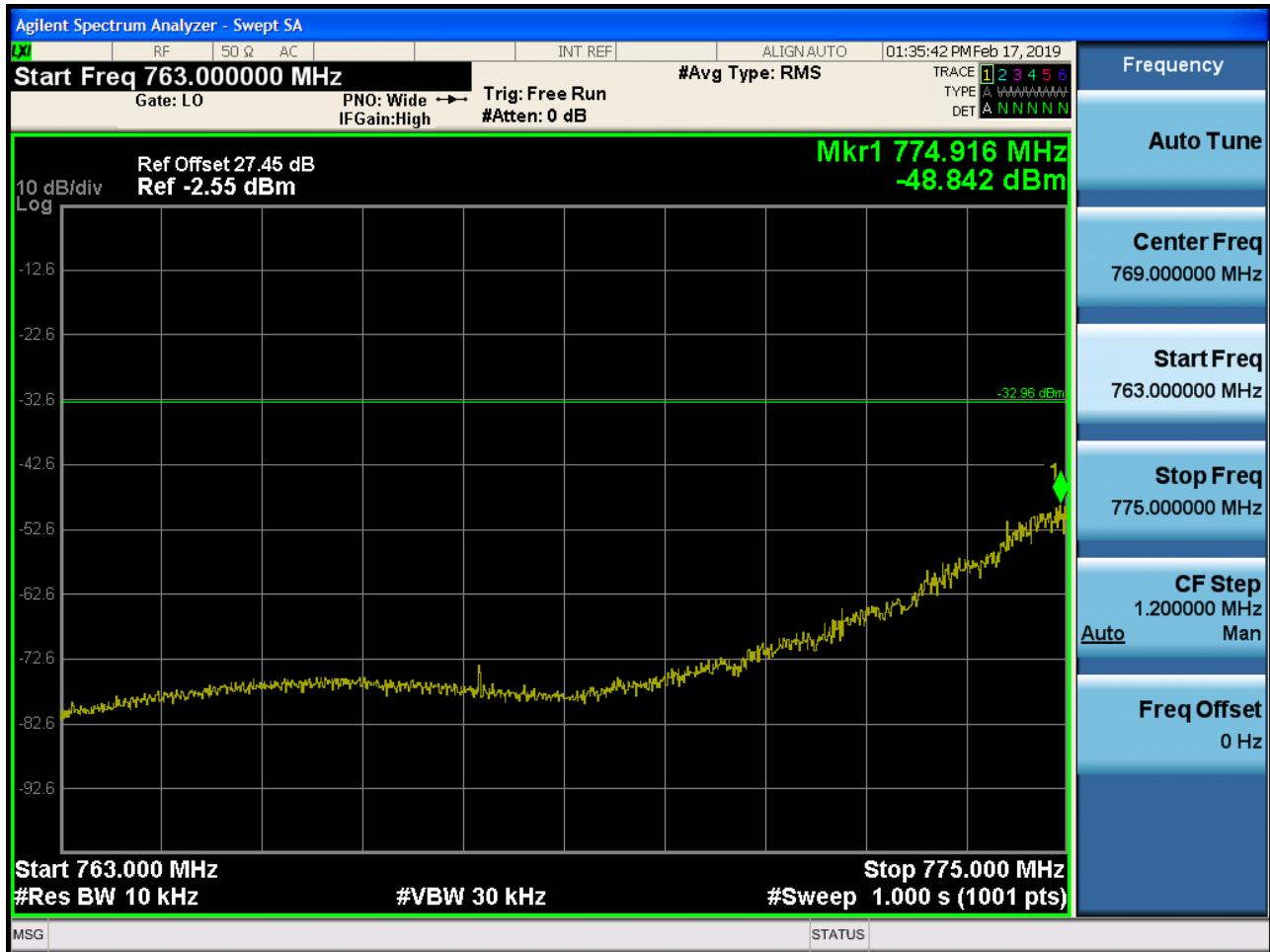
Band 13 Lower Band Edge Plot (10M BW Ch.23230 QPSK\_1RB)
