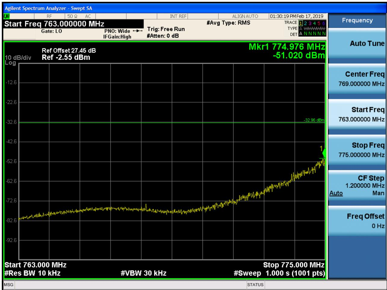
Band 13 Upper Band Edge Plot (5M BW Ch.23255 QPSK\_1RB)
