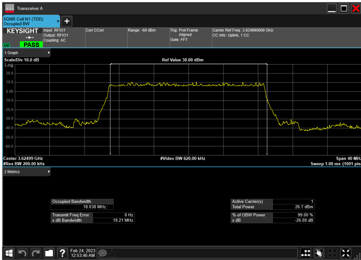
DC_5A_n48A_10MHz|20MHz_30kHz_836.5MHz|3624.99MHz_QPSK|DFT-s-OFDM PI/2 BPSK_RB1@50|RB50@0
