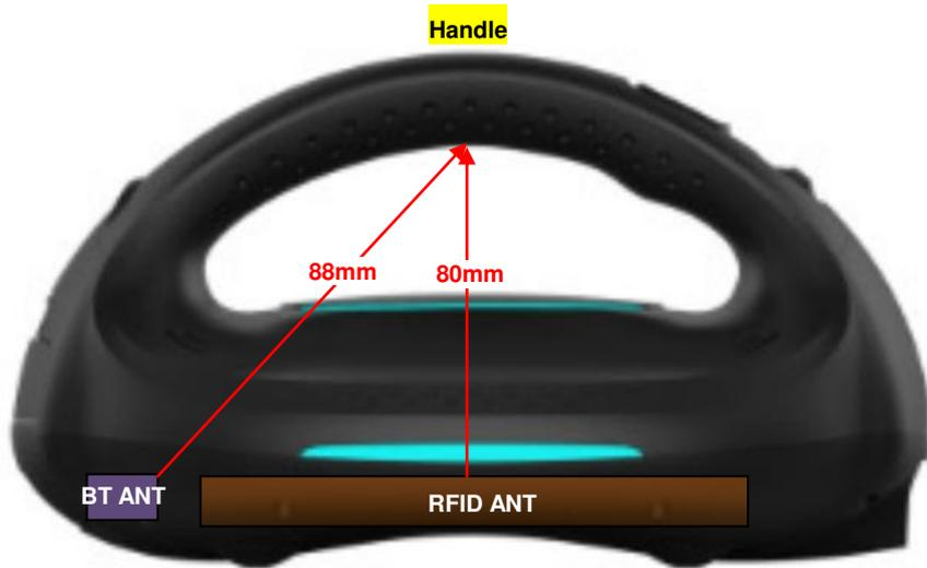
**SAR Test Setup Photos**
