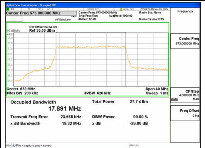
B71 / 20MHz / 64QAM/ Low CH
