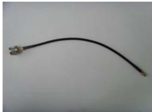
(그림4) 네트워크 측정 시 연장 Cable
