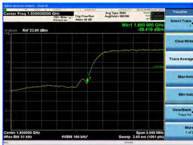
LTE Band 2 1.4MHz QPSK 1RB CH-Low
