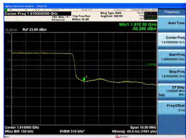
LTE Band 2 20MHz QPSK 1RB CH-High
