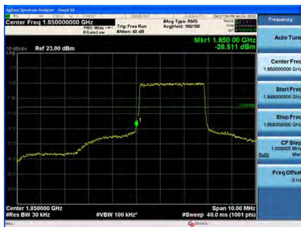
LTE Band 25 5MHz QPSK 1RB CH-Low
