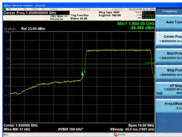
LTE Band 25 10MHz QPSK 1RB CH-Low
