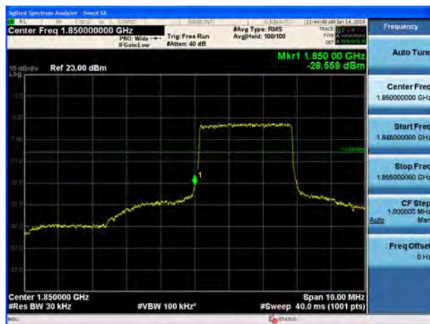
LTE Band 2 5MHz QPSK 1RB CH-Low
