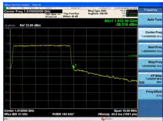
LTE Band 2 10MHz QPSK 1RB CH-High
