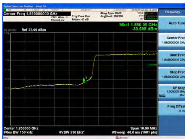
LTE Band 2 20MHz QPSK 1RB CH-Low
