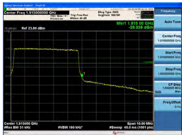
LTE Band 25 10MHz QPSK 1RB CH-High
