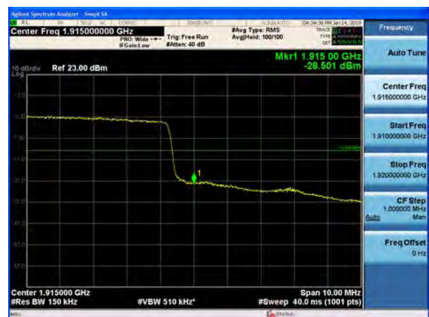
LTE Band 25 20MHz QPSK 1RB CH-High
