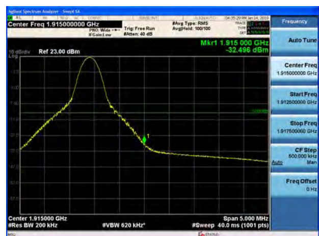
LTE Band 25 20MHz QPSK 1RB CH-High
