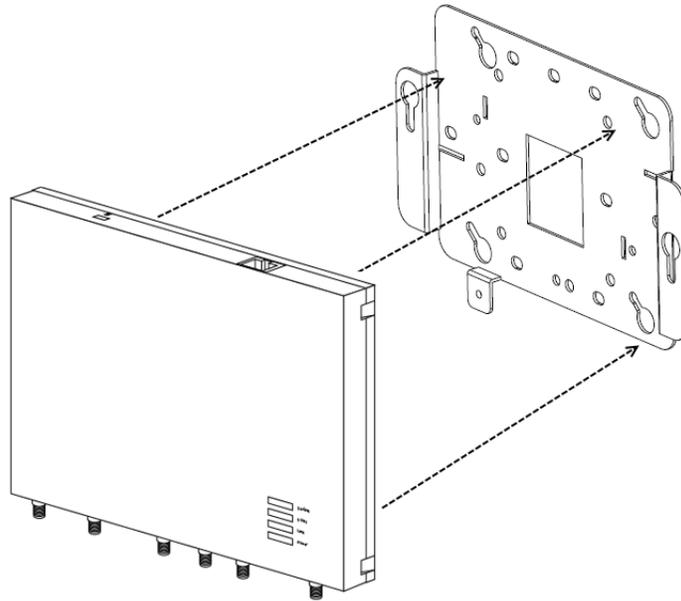
6. Permita que os pontos de acesso passem pelos slots, assegurando que as presilhas estejam fixadas na parte inferior do slot.
