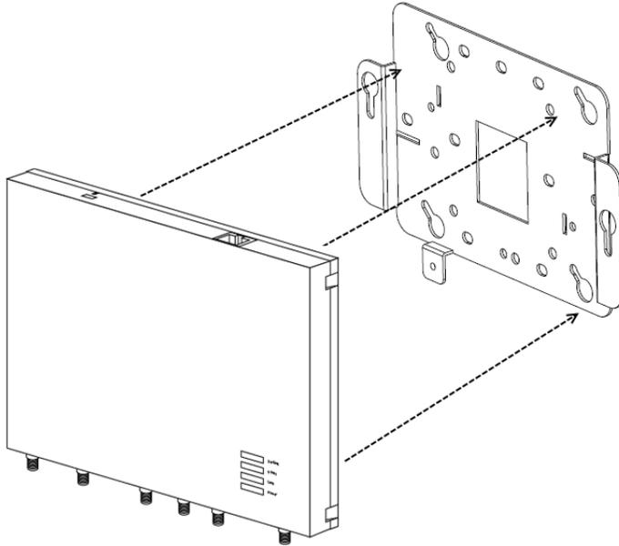
6. 允许接入点设备向下滑动钥匙孔插槽，确保接入点安装接片位于插槽底部。
