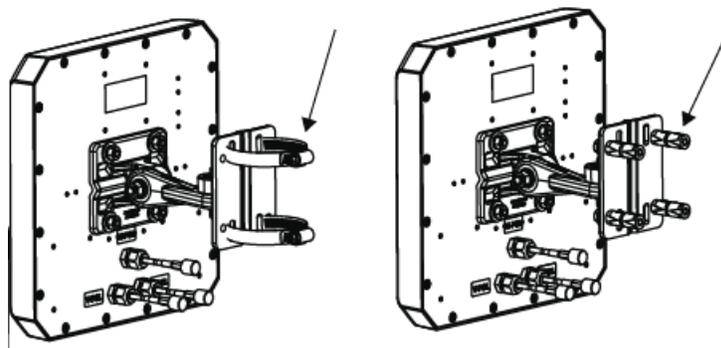
Se você estiver instalando antenas TYCO, prenda os suportes de montagem à parede e as antenas aos suportes de montagem.
