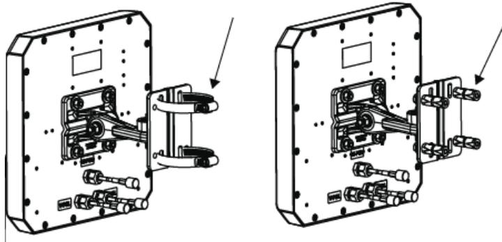
Werden TYCO-Antennen verwendet, müssen die Montagehalterungen an die Wand montiert werden. Die Antennen werden auf die Montagehalterungen aufgesetzt.
