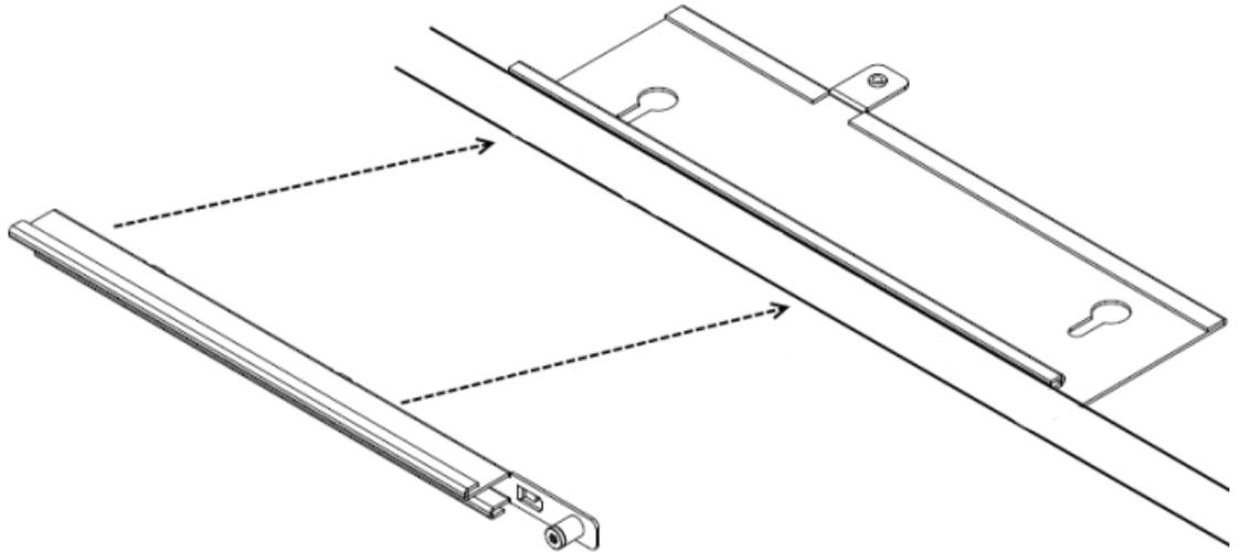
5. Befestigen Sie den Access Point an der Halterung. Richten Sie die Sicherungslaschen am Access Point an den Längsschlitz an der Deckenhalterung aus, und schieben Sie den Access Point vorsichtig auf die montierte Deckenhalterung. Wenn der Access Point richtig auf die Deckenhalterung aufgesetzt ist, kann die unverlierbare Daumenschraube auf dem Access Point in das Gewinde an der Deckenhalterung geschraubt werden.
