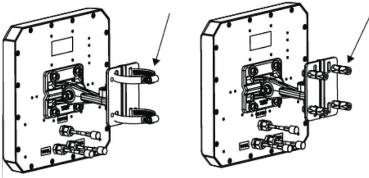
如果是安装 TYCO 天线，请将安装支架固定到墙壁，然后将天线连接到安装支架。
