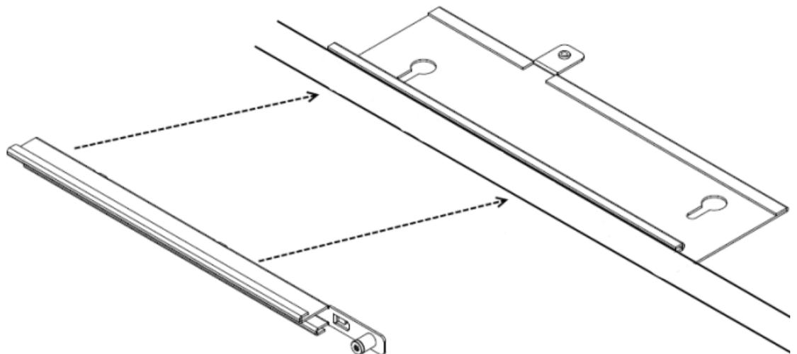
5. Fixez le point d'accès au support. Alignez les languettes de fixation du point d'accès avec les encoches en trous de serrure du support de la grille de plafond, puis faites glisser le point d'accès sur le dispositif de support de la grille de plafond avec soin. Si le point d'accès et le système de support sont correctement rattachés, il doit être possible d'insérer la vis captive du point d'accès dans la languette filetée du support de la grille de plafond.
