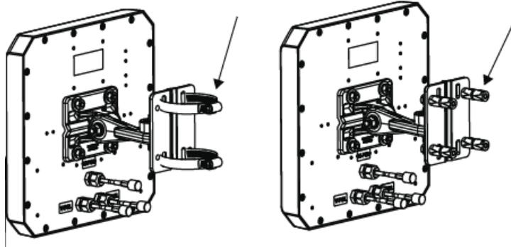
Pour installer des antennes Tyco, fixez les supports de montage au mur. Installez ensuite les antennes sur ces supports de montage.
