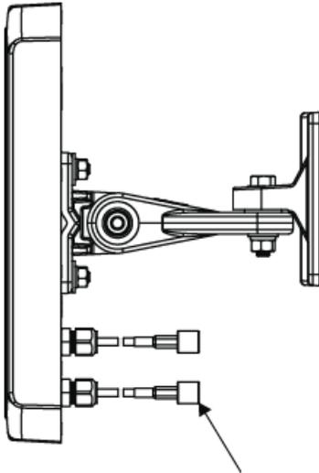
O suporte de montagem foi projetado para usar fixadores com diâmetros de seção aparafusados entre 3,5 mm e 4,5 mm. Se os fixadores tiverem diâmetros aparafusados maiores de 3,5 mm, somente os dois furos marcados "A" poderão ser usados. Se os fixadores tiverem diâmetros menores de 3,5 mm, os furos marcados "A" e "B" poderão ser usados. Todos os fixadores de parede devem ter um diâmetro de cabeça menor de 10 mm ou não será possível instalar o suporte de montagem sobre eles.
