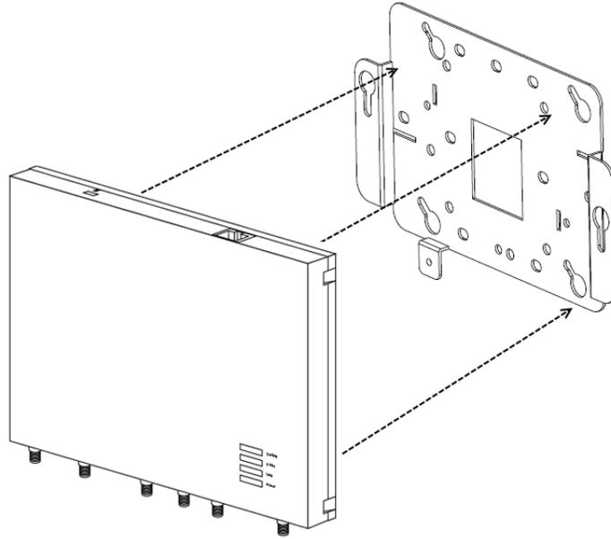
6. Faites glisser le point d'accès dans les encoches en trous de serrure en veillant à ce que ses languettes de montage soient correctement installées dans la partie inférieure des encoches.
