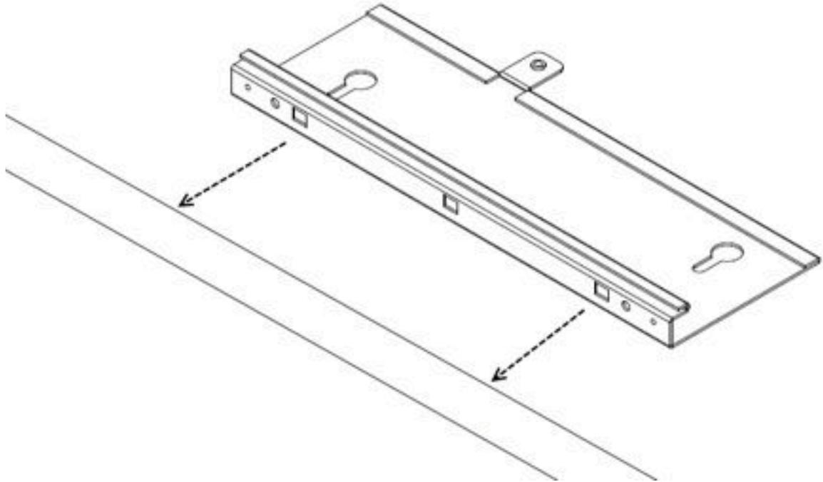
4. 安装小支架与大支架之间的联锁装置，用夹具将这两个支架固定在龙骨上。小支架上具有接片，大接片上有插槽。这可使两个部件连接在一起，并相互锁定。此步骤完成后，两个支架即可牢固地夹紧在吊顶龙骨周围。支架的两半正确地连接在一起后，小支架上的系留紧固件应与大支架上的螺纹相啮合。使用螺丝刀拧紧系留紧固件。以此方式固定两个支架，以防止相互脱离。牢固地拧紧系留紧固件的螺丝。
