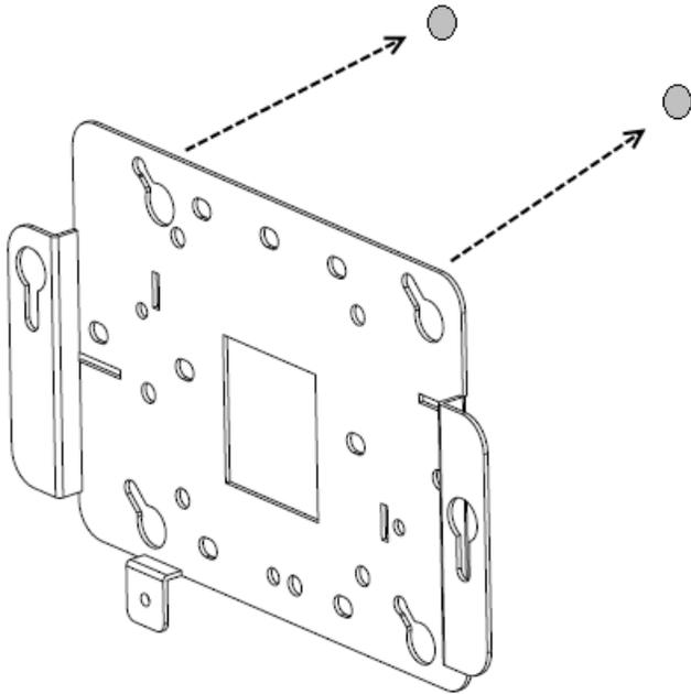
4. 拧紧螺丝，将墙壁安装支架紧紧地固定在墙壁上。
