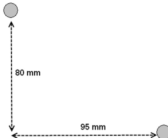
O suporte de parede foi projetado para usar um mínimo de 2 fixadores e um máximo de 4.
