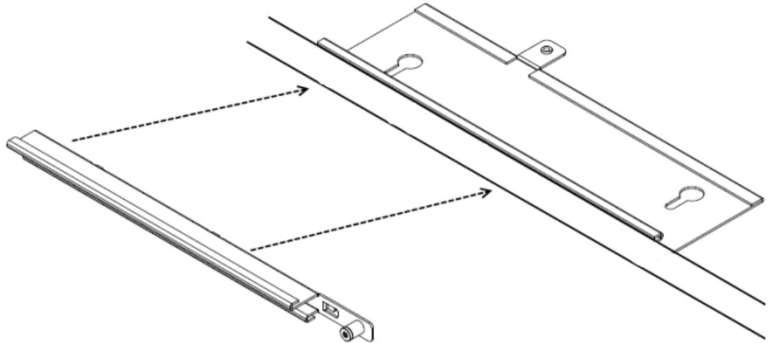
5. Monte el punto de acceso en el soporte. Alinee las lengüetas del punto de acceso con las ranuras con forma de cerradura del adaptador para estructuras de techos desmontables e inserte con cuidado el punto de acceso en el adaptador. Si tanto el punto de acceso como el adaptador están bien colocados, el tornillo imperdible de ajuste manual del punto de acceso tiene que coincidir con la lengüeta roscada del adaptador para estructuras de techos desmontables.
