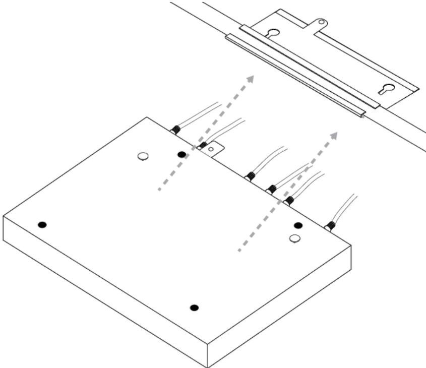
6. 将外部天线安装到距离接入点指定距离内的墙壁上。
