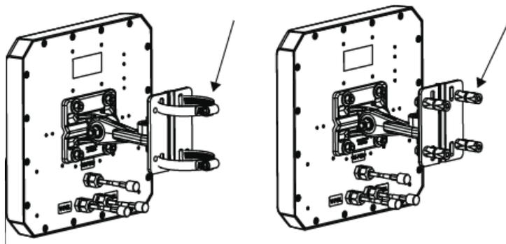
Si instala antenas TYCO, fije los soportes de montaje a la pared y fije las antenas a los soportes de montaje.
