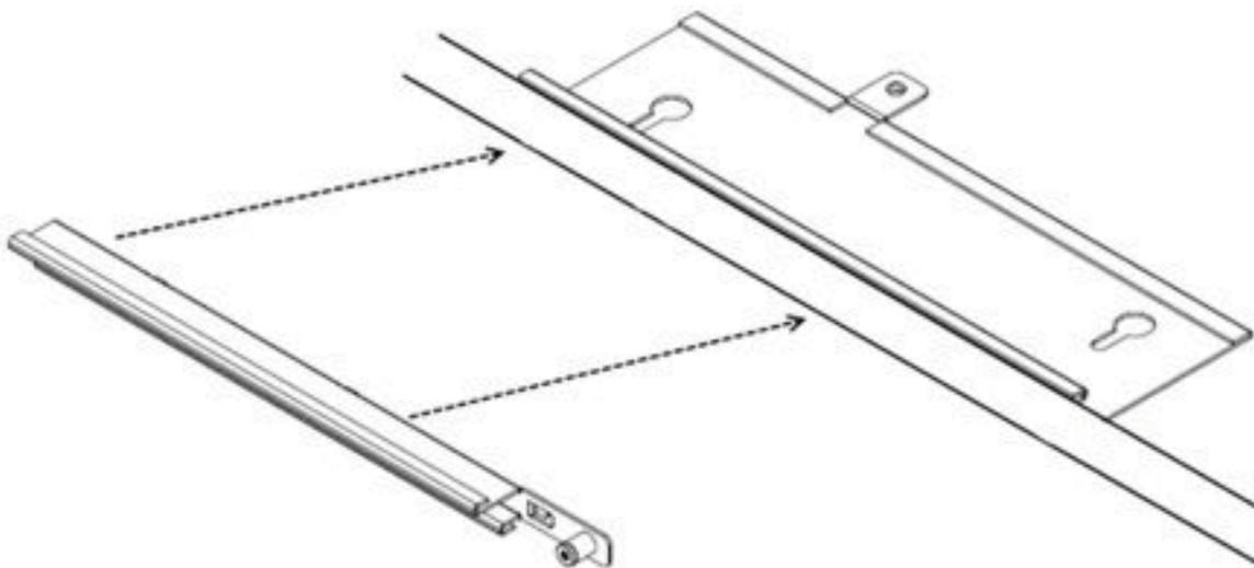
5. 将接入点设备安装到支架。将接入点设备的固定接片与吊顶龙骨支架上的钥匙孔插槽对齐，小心将接入点设备滑到吊顶龙骨支架组件上。如果接入点设备和支架组件正确啮合，应可将接入点设备的外加手旋螺丝放入吊顶龙骨支架上的螺纹接片。
