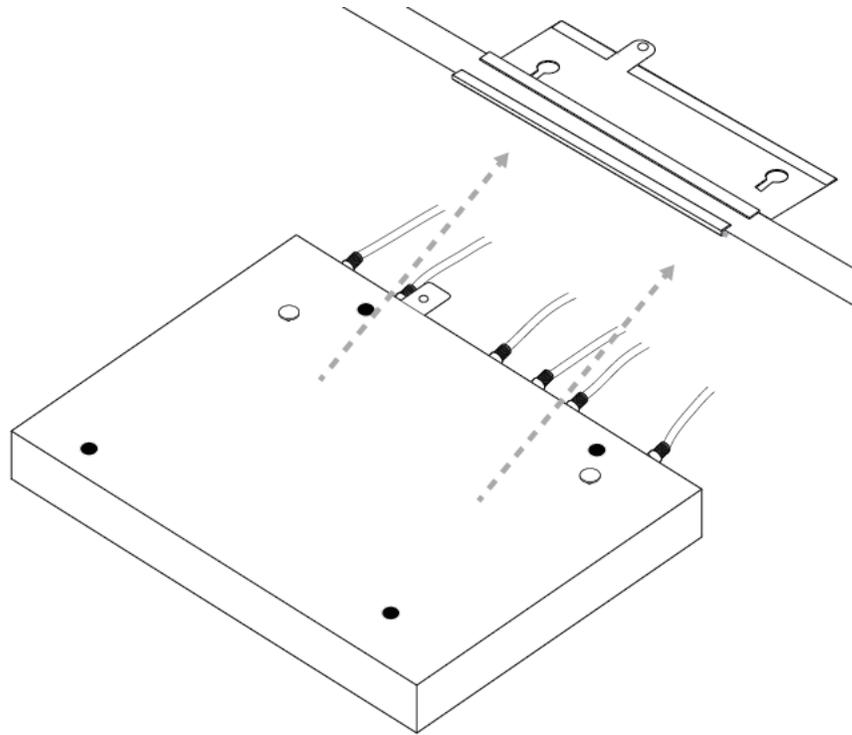
6. Monte as antenas externas na parede dentro da distância especificada do ponto de acesso.
