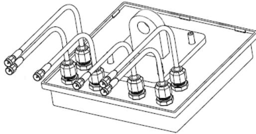
10. Assurez-vous que les antennes sont correctement fixées au mur (ou au support, en cas d'installation d'une antenne Laird).
