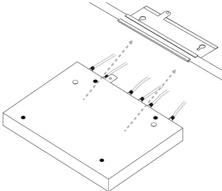
6. Monte las antenas externas a la pared dentro de la distancia especificada del punto de acceso.
