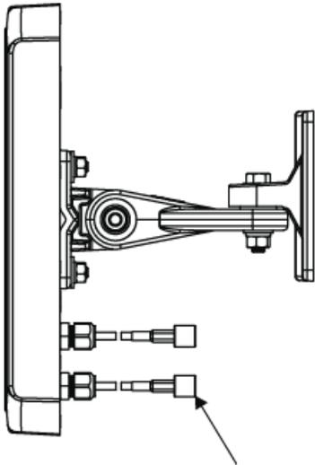
Der Adapter für die Deckenmontage verfügt über zwei ineinander greifende Halterungen. Die Montagelaschen unten am Access Point passen in die Längsschlitze an der größeren Halterung. Die unverlierbare Schraube am Access Point wird in das Gewindeloch an der größeren Halterung geschraubt. Die unverlierbare Schraube an der kleineren Halterung kann je nach Rastergröße auf zweierlei Weise an der größeren Halterung ausgerichtet werden.
