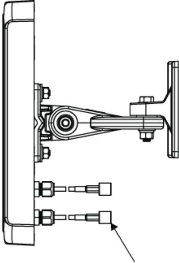
安装支架可使用螺纹直径范围在 3.5mm 至 4.5mm 之间的墙壁预埋件。如果墙壁预埋件的螺纹直径大于 3.5mm，则只可使用两个标记了 'A' 的安装孔。如果墙壁预埋件的螺纹直径小于 3.5mm，则均可使用标记了 'A' 和 'B' 的安装孔。所有墙壁预埋件的头部直径必须小于 10mm，否则无法在其上安装墙壁安装支架。
