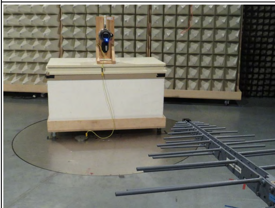
EUT 1 test setup 200 - 1000MHz horizontal
