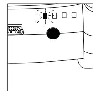
5) Quando la batteria dell'AP.2 funziona lentamente, il LED lampeggerà velocemente. Dovrete caricare presto il comando per evitare l'interruzione del gioco.
