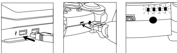
3) Quando la carica è completa il LED dell'AP.2 si spegne. A questo punto, inserire l'adattatore USB link wire less AFTERGLOW in una delle porte USB della PlayStation®3 mentre il sistema è acceso. Premere qualsiasi tasto sull' AP.2 e avrà luogo un'accoppiamento automatico.
