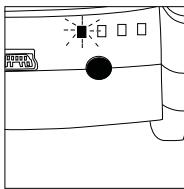
5) Når din AP.2's batteri er ved at være tomt, begynder indicator LED'en at blinke hurtigt. Du bør genoplade din kontrolenhed hurtigst muligt for at undgå at skulle afryde spillet.
