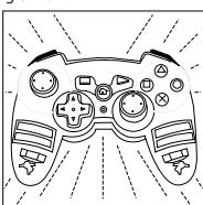
4) Tryk på AFTERGLOW® knappen en gang for at skifte til "VIBRATION" indstilling. Kontrolenheden lyser i denne indstilling når AP.2 rumletemotoren bliver aktiveret.
