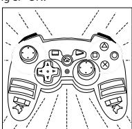
4) Tryk på AFTERGLOW® knappen en gang for at skifte til "VIBRATION" indstilling. Kontrolenheden lyser i denne indstilling når AP.2 rumlemotoren bliver aktiveret.
