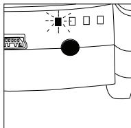
5) Når din AP.2's batteri er ved at være tomt, begynder indicator LED'en at blinke hurtigt. Du bør genoplade din kontrolenhed hurtigst muligt for at undgå at skulle afbryde spillet.
