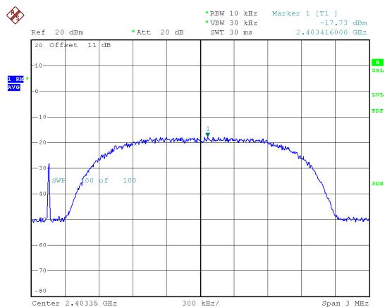
Modulation Type:  $\pi/4$ -DQPSK
