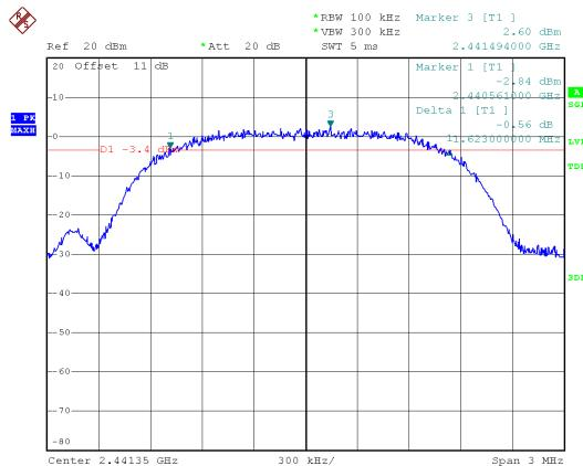
Modulation Type:  $\pi/4$ -DQPSK
