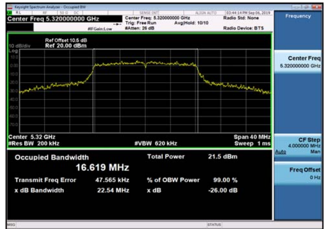
U-NII-2c 26dB Bandwidth-802.11n(20MHz )5600MHz
