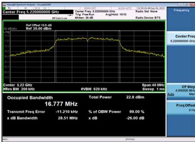
U-NII-1 26dB Bandwidth-802.11a(20MHz) ,5220MHz
