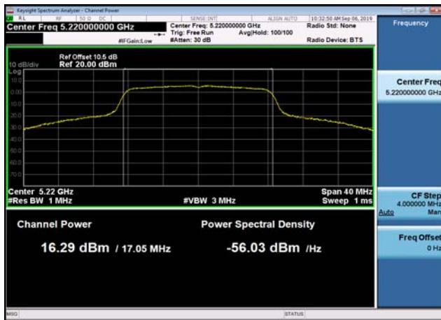
U-NII-1 Output Power-802.11a(20MHz) ,5220MHz
