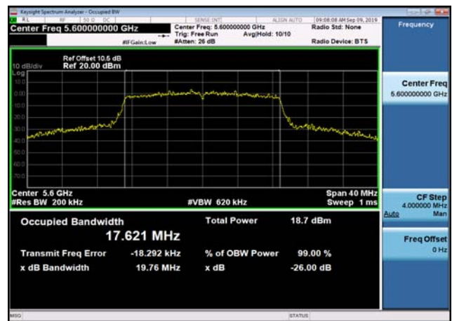
U-NII-2c 26dB Bandwidth-802.11n(20MHz )5600MHz
