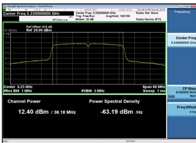
U-NII-1 Output Power-802.11n(40MHz) ,5230MHz
