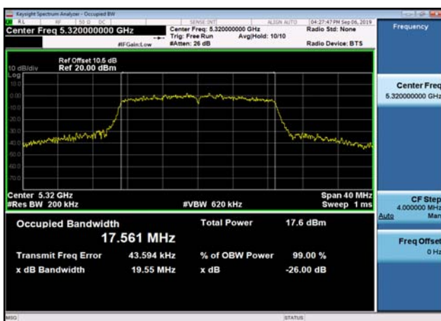
U-NII-2a 26dB Bandwidth-802.11n(20MHz) ,5320MHz
