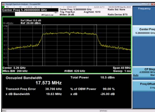
U-NII-2a 26dB Bandwidth-802.11n(20MHz) ,5320MHz
