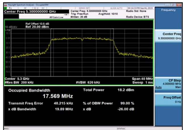
U-NII-2a 26dB Bandwidth-802.11n(40MHz) ,5270MHz
