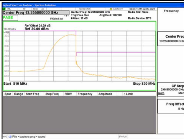
B26 Part90 / 5MHz / High CH / QPSK / 1 RB
