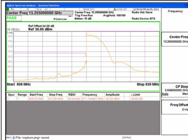
B26 Part90 / 3MHz / Low CH / QPSK / 1 RB
