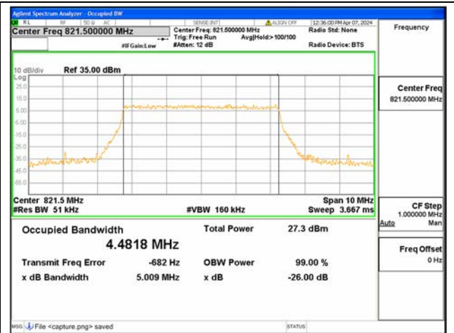
B26 Part90 / 5MHz / 16QAM / High CH
