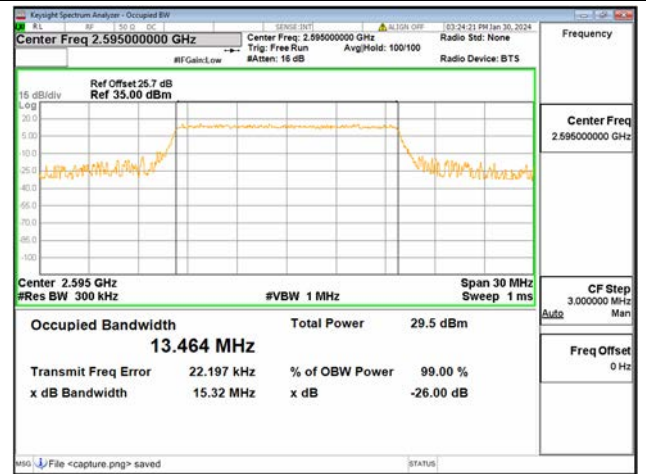
B38 / 15MHz / QPSK/ Mid CH
