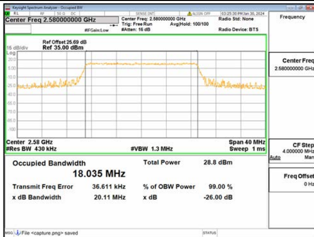
B38 / 20MHz / 16QAM/ Low CH
