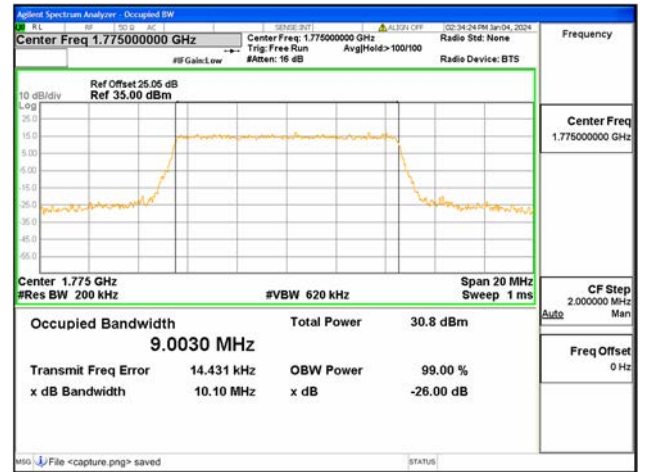
B66 / 10MHz / QPSK / High CH
