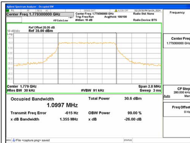
B66 / 1.4MHz / QPSK/ High CH
