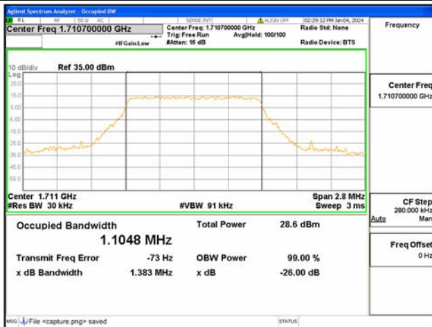
B66 / 1.4MHz / 64QAM / Low CH
