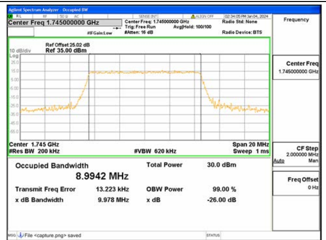
B66 / 10MHz / 16QAM / Mid CH
