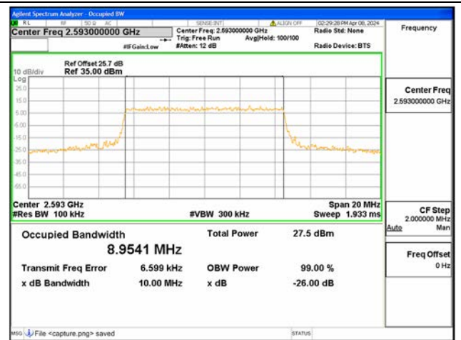
B41 / 10MHz / 16QAM / Mid CH
