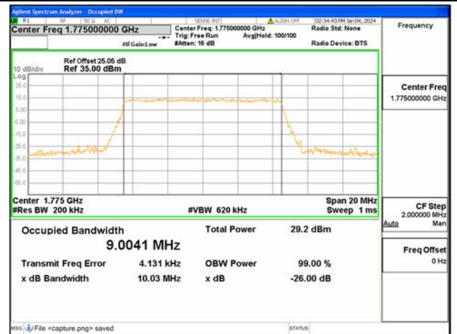
B66 / 10MHz / 64QAM / High CH
