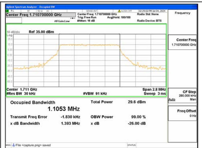
B66 / 1.4MHz / 16QAM / Low CH
