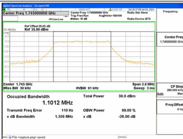
B66 / 1.4MHz / 16QAM / Mid CH
