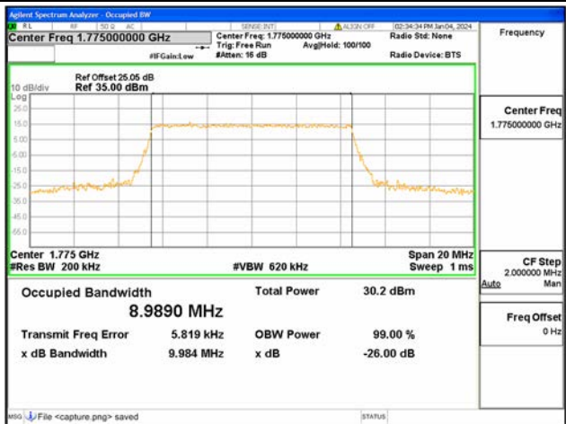
B66 / 10MHz / 16QAM / High CH
