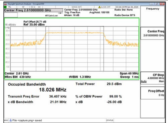
B38 / 20MHz / QPSK / High CH
