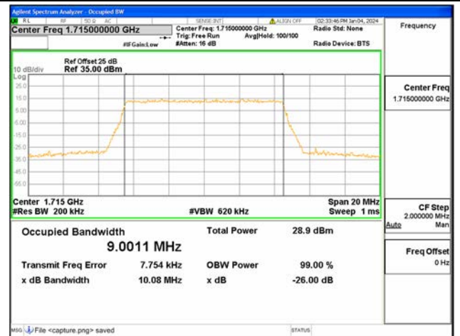
B66 / 10MHz / 64QAM/ Low CH
