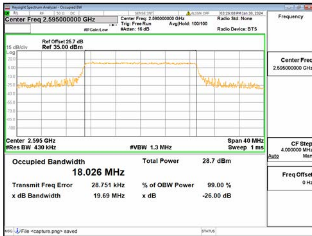
B38 / 20MHz / 64QAM / Mid CH
