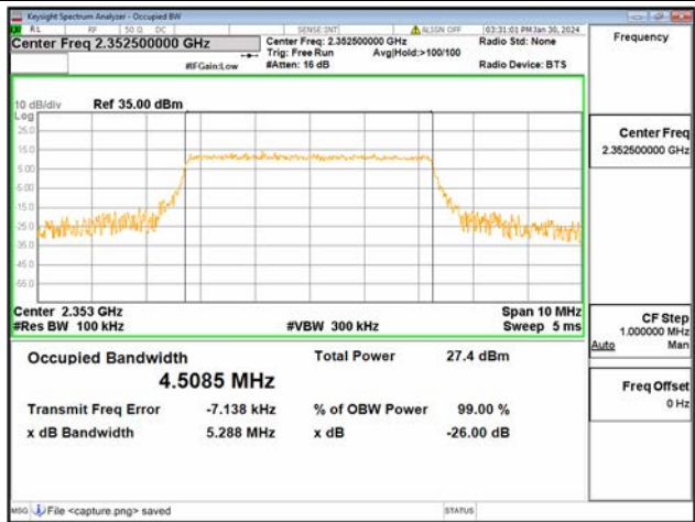
B40-2 / 5MHz / 64QAM / Low CH
