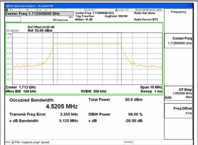
B66 / 5MHz / 16QAM/ Low CH
