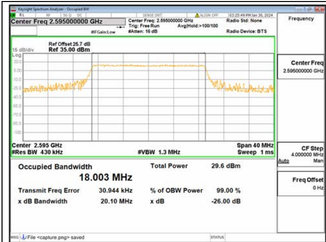
B38 / 20MHz / QPSK / Mid CH
