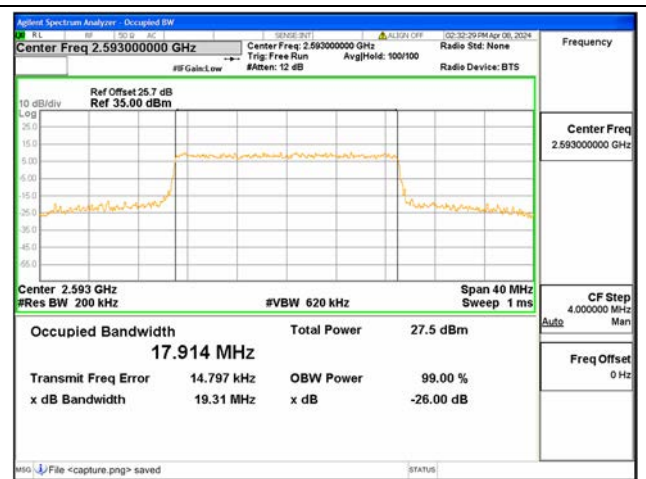
B41 / 20MHz / 16QAM / Mid CH
