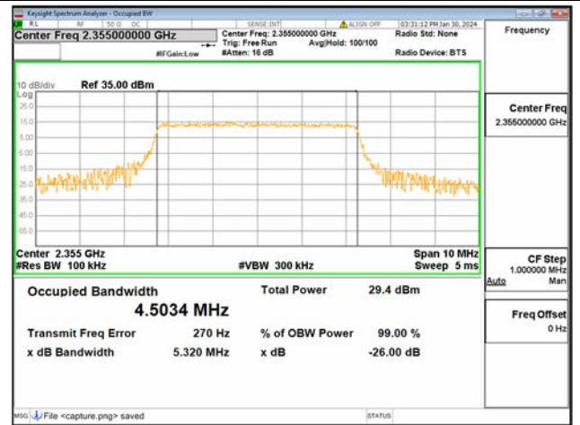
B40-2 / 5MHz / QPSK / Mid CH
