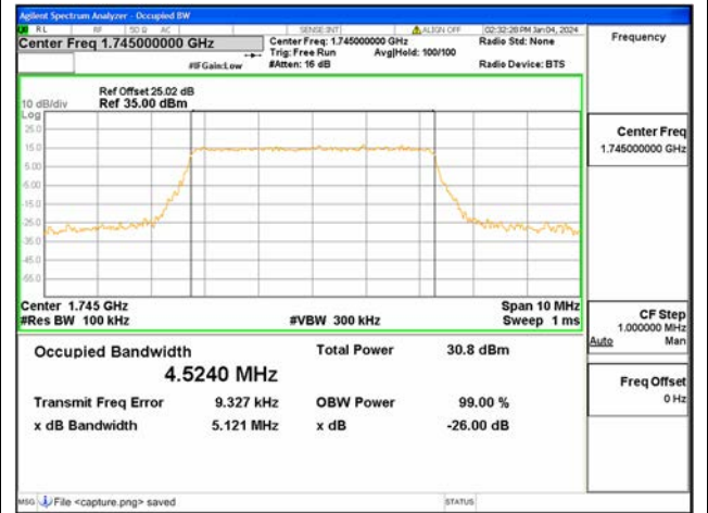
B66 / 5MHz / QPSK/ Mid CH
