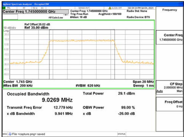
B66 / 10MHz / 64QAM / Mid CH
