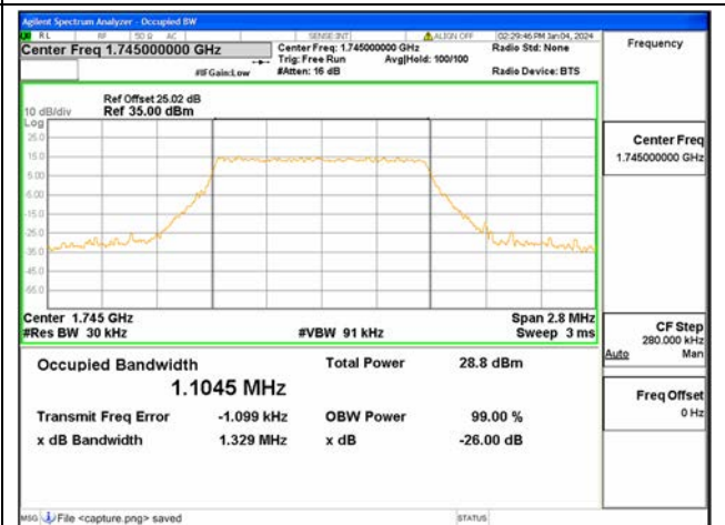
B66 / 1.4MHz / 64QAM / Mid CH
