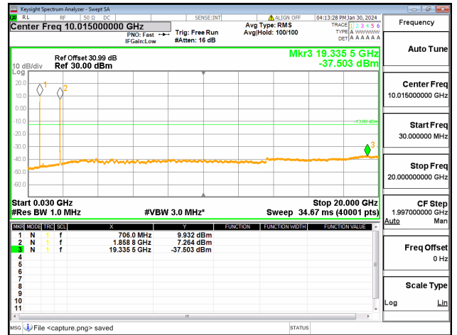
2A-12A / 20+10MHz / QPSK / Low+Mid CH / 100@0-50@0
