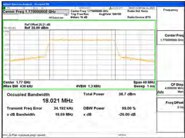
B66 / 20MHz / QPSK/ High CH
