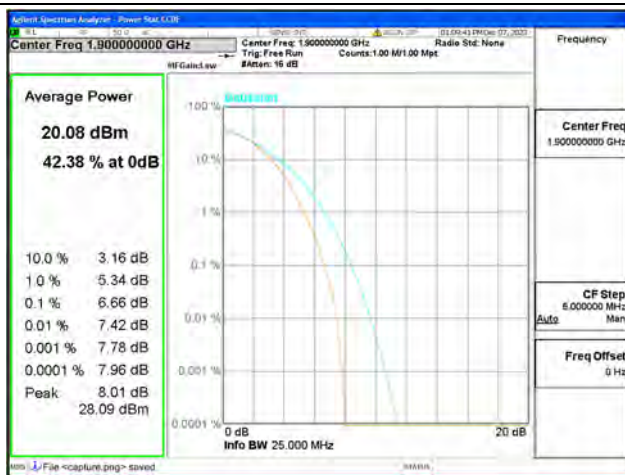
B2 / 20MHz / High CH / 64QAM
