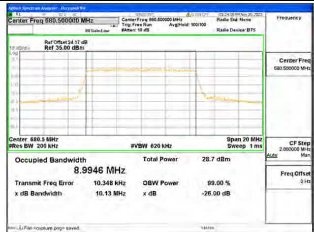
B71 / 10MHz / 16QAM/ Mid CH
