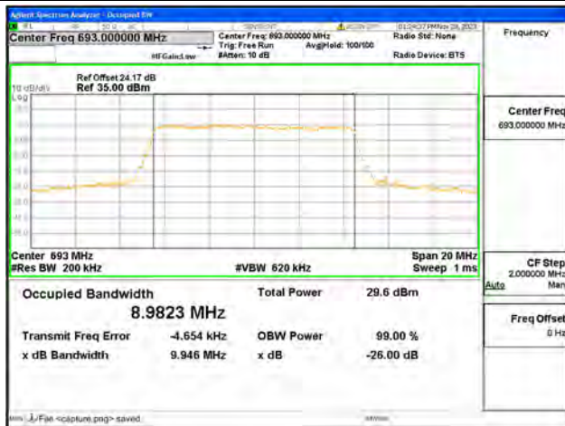
B71 / 10MHz / QPSK/ High CH
