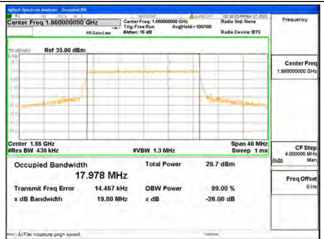
B2 / 20MHz / 16QAM/ Low CH
