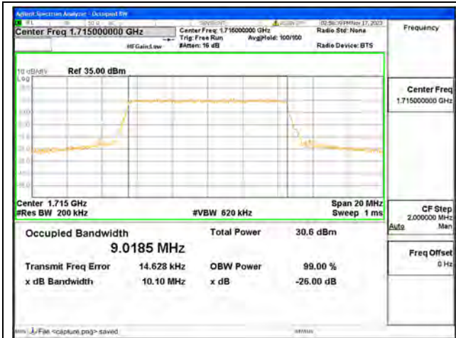
B4 / 10MHz / QPSK/ Low CH
