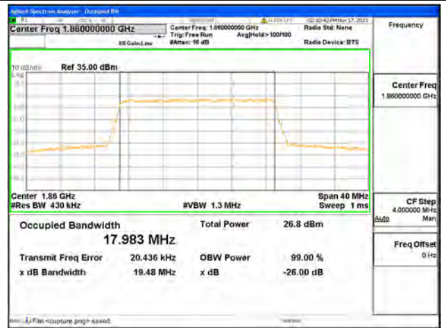
B2 / 20MHz / 256QAM/ Low CH
