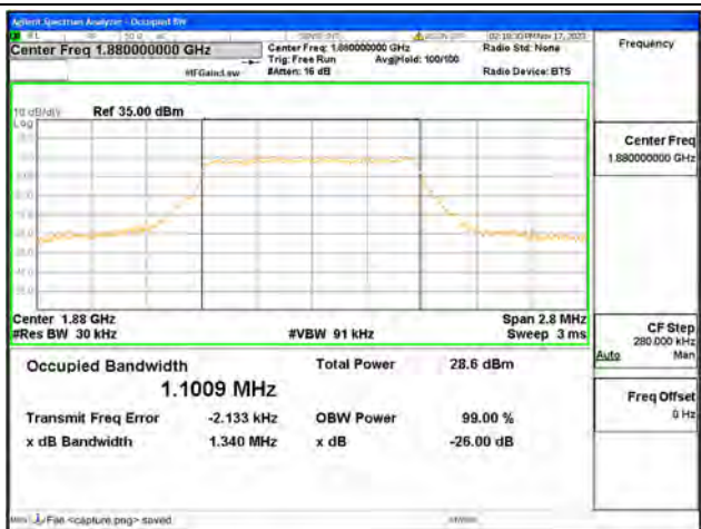
B2 / 1.4MHz / QPSK/ Mid CH
