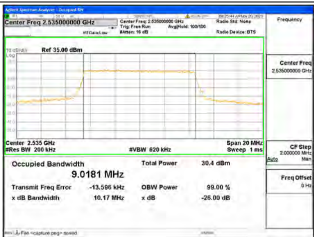
B7 / 10MHz / QPSK/ Mid CH
