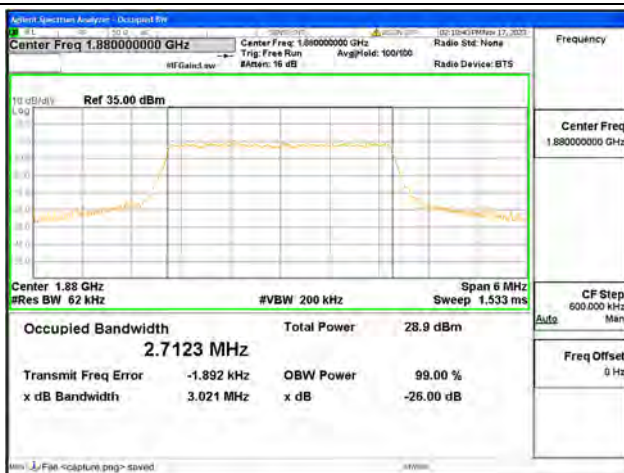
B2 / 3MHz / QPSK / Mid CH
