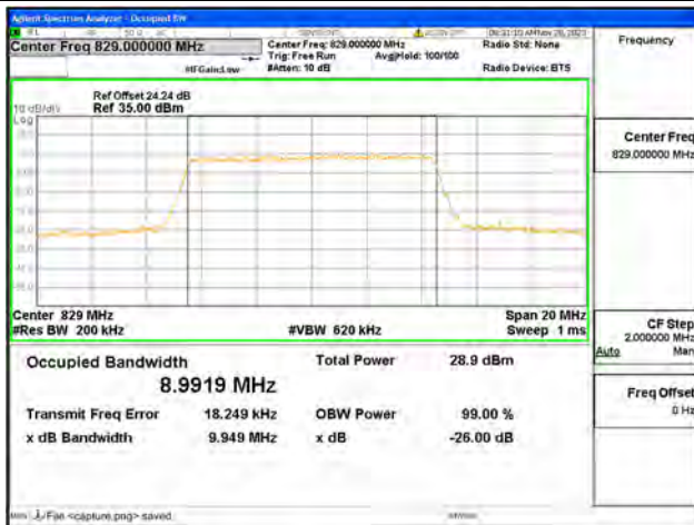
B5 / 10MHz / 64QAM/ Low CH
