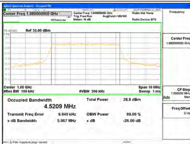
B2 / 5MHz / QPSK/ Mid CH
