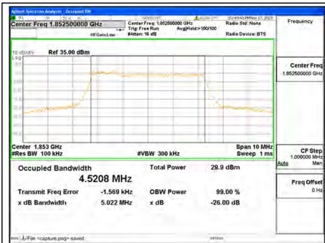
B2 / 5MHz / QPSK/ Low CH
