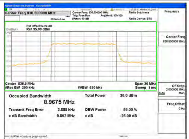
B5 / 10MHz / 256QAM/ Mid CH
