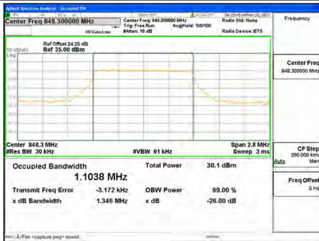
B5 / 1.4MHz / QPSK/ High CH
