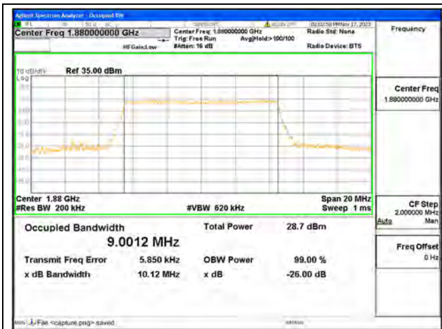
B2 / 10MHz / 64QAM/ Mid CH
