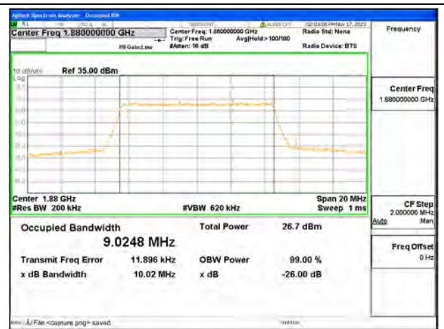
B2 / 10MHz / 256QAM/ Mid CH
