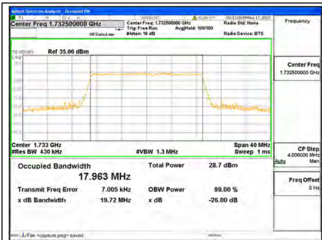
B4 / 20MHz / 64QAM/ Mid CH
