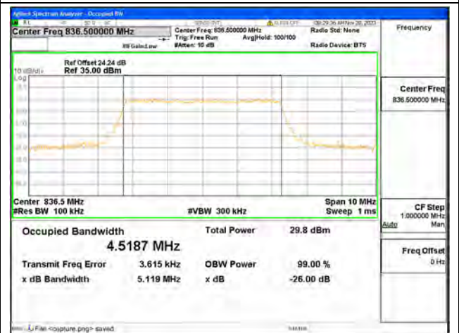
B5 / 5MHz / 16QAM/ Mid CH
