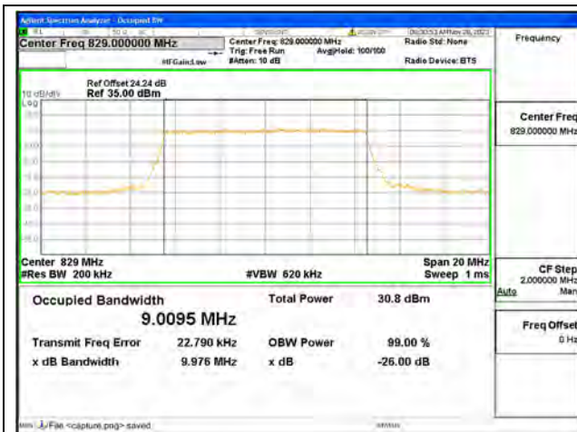
B5 / 10MHz / QPSK/ Low CH
