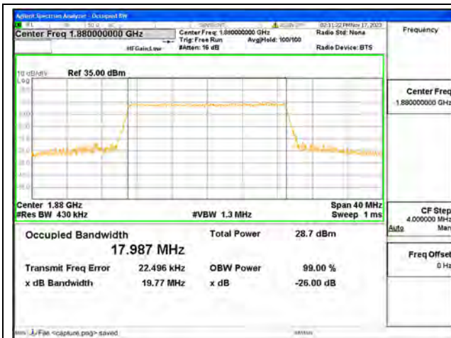
B2 / 20MHz / 64QAM/ Mid CH
