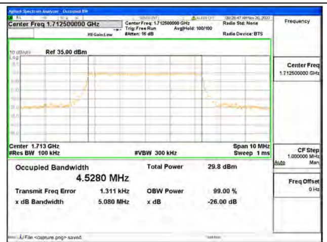
B4 / 5MHz / 16QAM / Low CH
