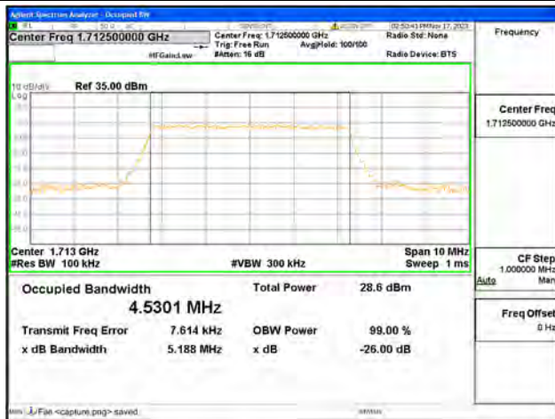
B4 / 5MHz / 64QAM / Low CH
