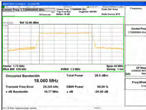
B4 / 20MHz / 64QAM/ Low CH
