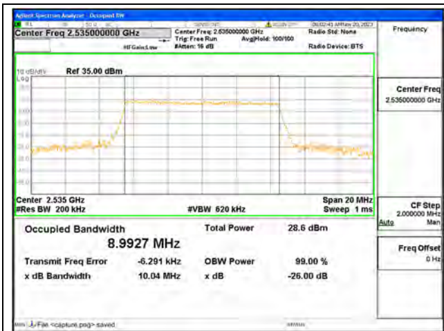
B7 / 10MHz / 64QAM/ Mid CH
