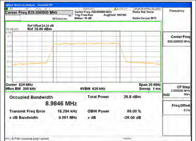
B5 / 10MHz / 256QAM/ Low CH
