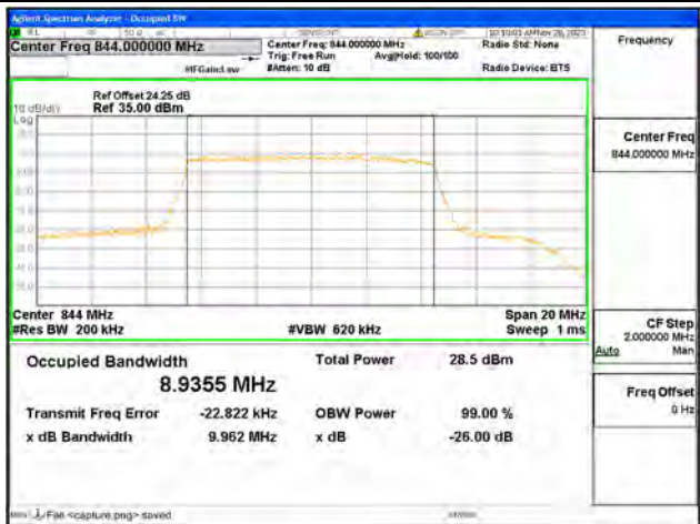
B5 / 10MHz / 64QAM/ High CH
