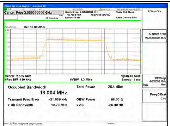
B7 / 20MHz / 256QAM/ Mid CH
