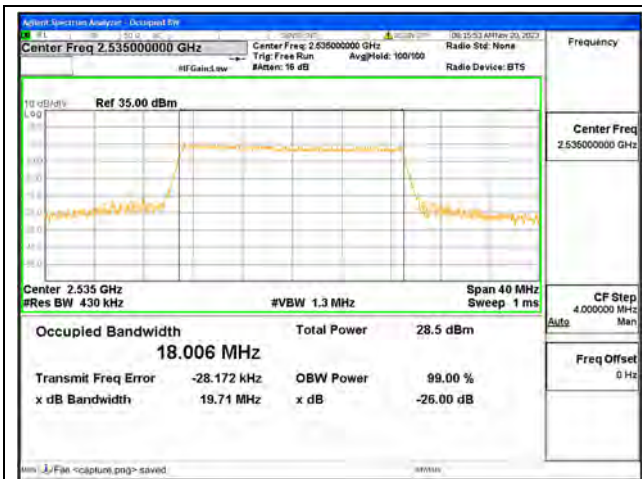
B7 / 20MHz / 64QAM/ Mid CH
