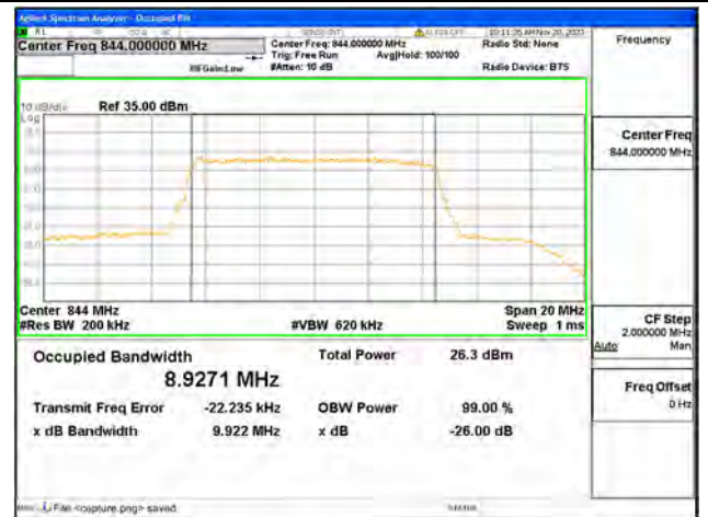
B5 / 10MHz / 256QAM/ High CH
