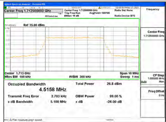
B4 / 5MHz / 256QAM / Low CH
