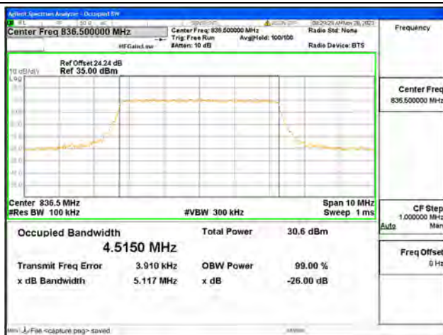
B5 / 5MHz / QPSK/ Mid CH
