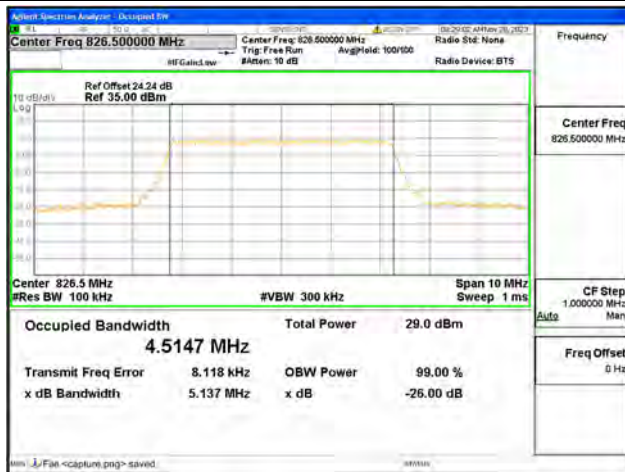
B5 / 5MHz / 64QAM/ Low CH
