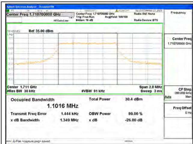
B4 / 1.4MHz / QPSK/ Low CH
