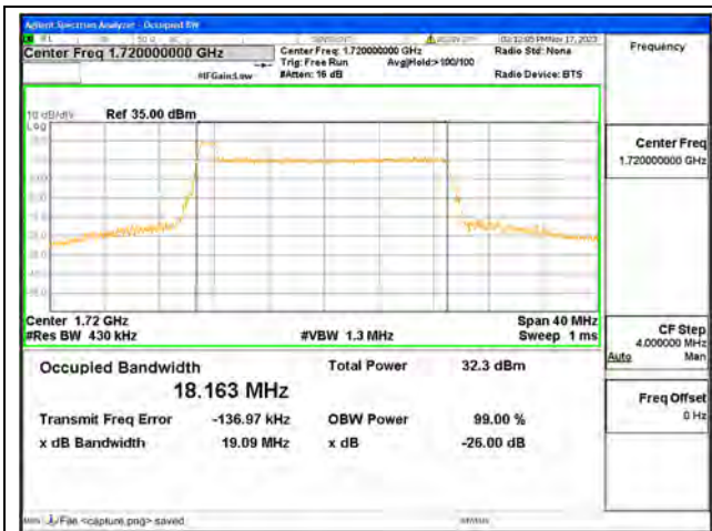
B4 / 20MHz / QPSK/ Low CH
