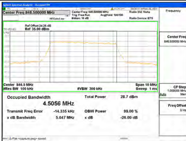
B5 / 5MHz / 64QAM/ High CH
