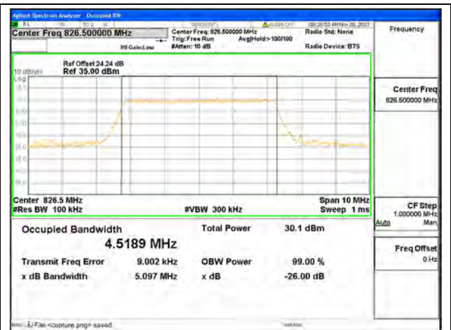
B5 / 5MHz / 16QAM/ Low CH
