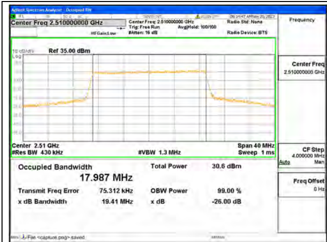
B7 / 20MHz / QPSK/ Low CH
