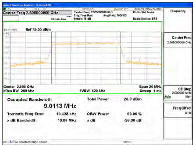
B7 / 10MHz / 64QAM/ Low CH
