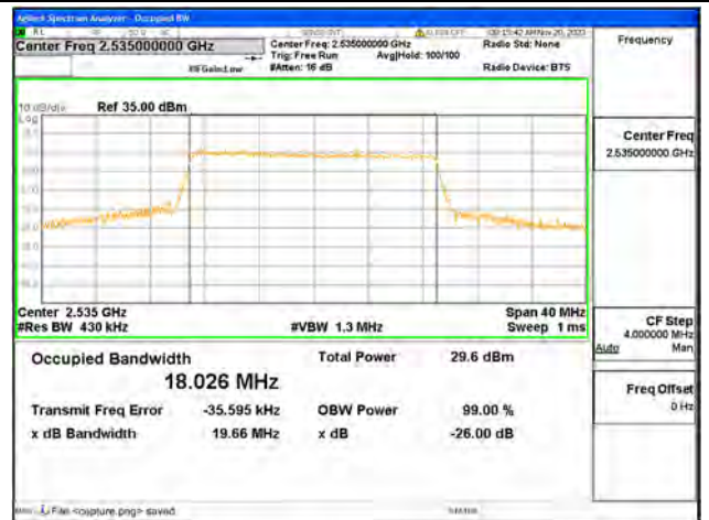
B7 / 20MHz / 16QAM/ Mid CH
