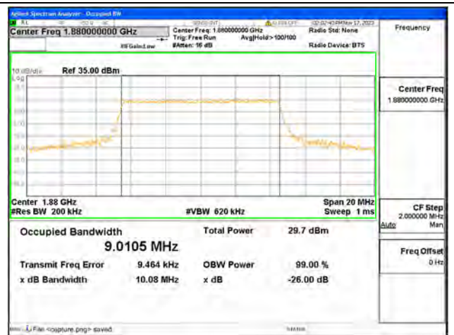
B2 / 10MHz / 16QAM/ Mid CH
