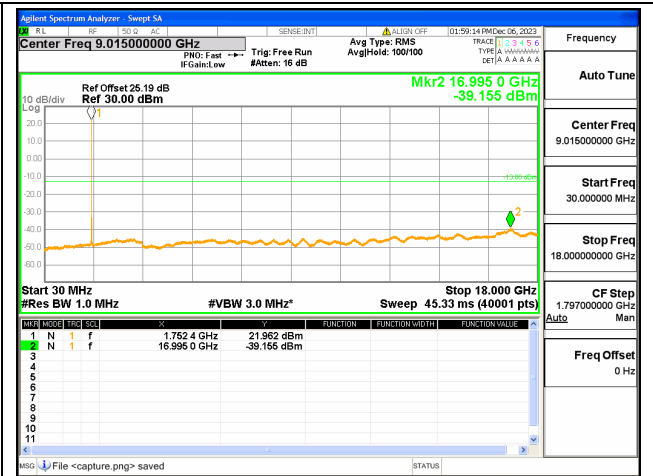
66C / 10+15MHz / QPSK / Mid CH / 1@49-1@0
