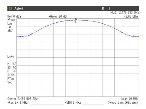
Modulation: Π/4-DQPSK Lowest Channel: 2402 MHz.
