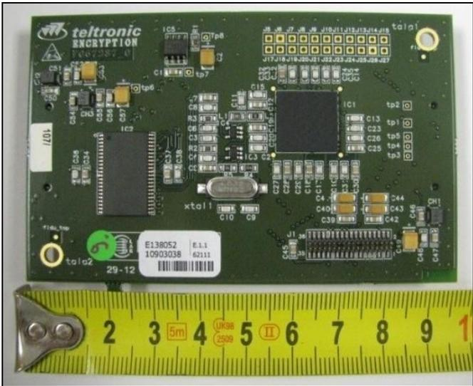
**4.6 LOWER SIDE OF THE ENCRYPTION PCB**
