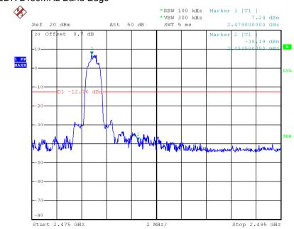
Test Mode : EDR 2480MHz Band Edge
