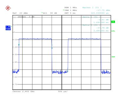
Test mode: π/4DQPSK Test Packet: 2-DH5
