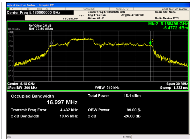
IEEE 802.11ax_Channel 36_20MHz_Antenna 2_RU&Index 52RU38
