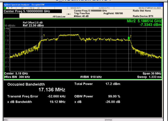
IEEE 802.11ax_Channel 36_20MHz_Antenna 0_RU&Index 52RU38
